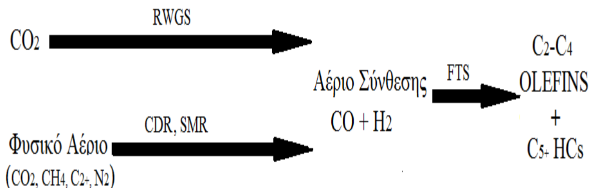
Σχήμα 11. Στάδια μετατροπής υλικών τροφοδοσίας σε προϊόντα HCs
