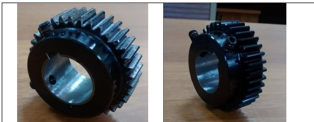
Σχήμα 3.3 Άποψη οδοντωτού τροχού με φθαρμένες επιφάνειες.
