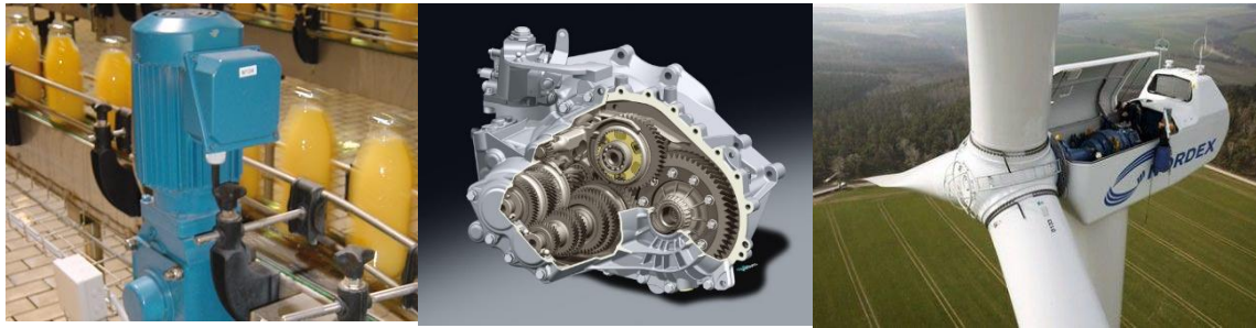
α) Μειωτήρας πλάγιας οδόντωσης, β) κιβώτιο ταχυτήτων αυτοκινήτου και γ) πλανητικό κιβώτιο ανεμογεννήτριας.
