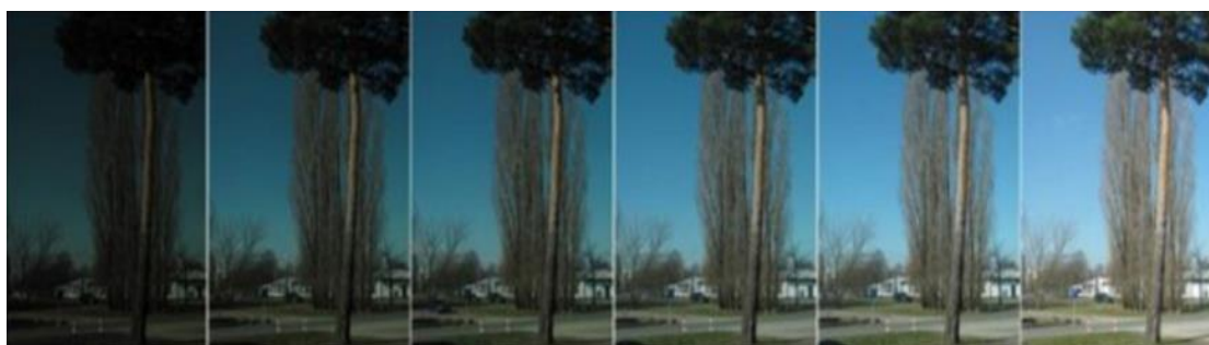
Εικόνα 26: Απεικόνιση σταδίων αλλαγής των οπτικών ιδιοτήτων ενός θερμοχρωμικού παραθύρου [92]
