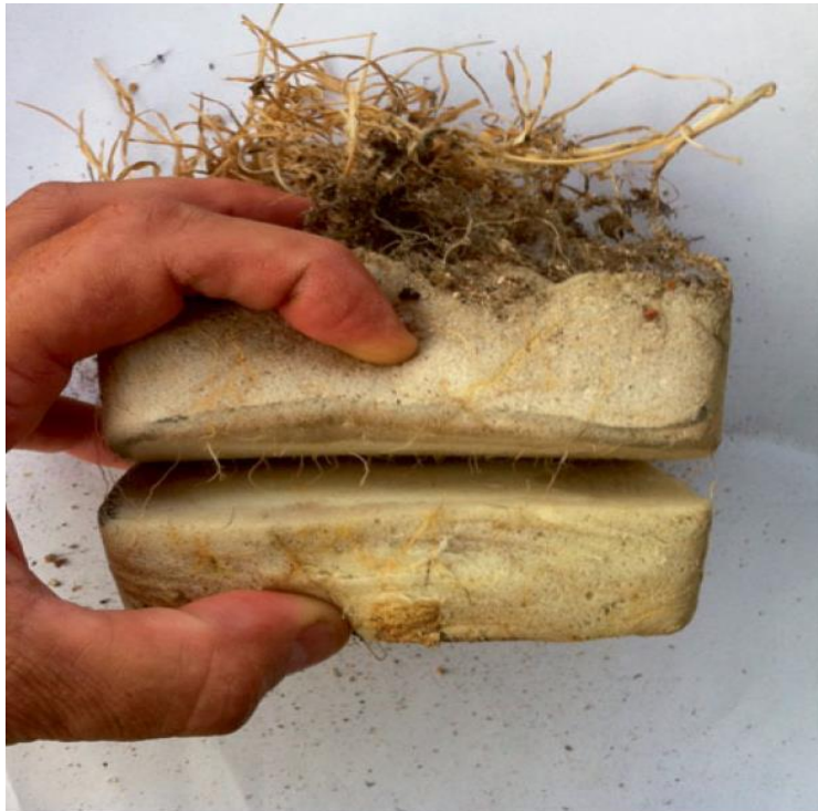
Εικόνα 22: Υδροπονικός αφρός ως στρώμα κατακράτησης νερού
