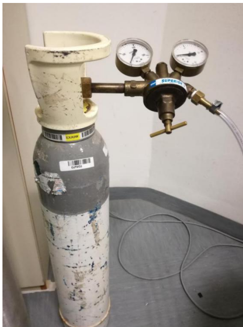
Σχήμα 1 : Φιάλη διοξειδίου του άνθρακα και ρυθμιστική διάταξη με μανόμετρα μέτρησης πίεσης προ και μετά της βαλβίδας στραγγαλισμού της
