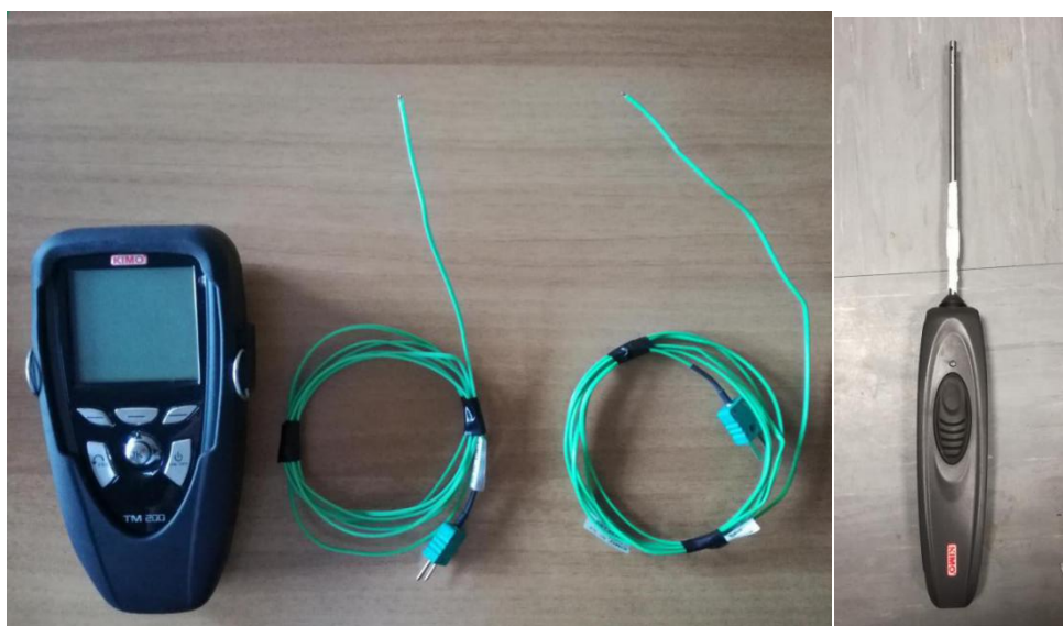
Σχήμα 3: Θερμόμετρο TM 200 της εταιρείας KIMO μαζί με δύο θερμοστοιχεία και τον αισθητήρα ασύρματης σύνδεσης Pt 100
