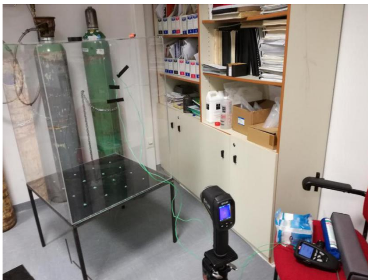
Σχήμα 4: Τοποθέτηση θερμογραφικής κάμερας TG 165 για την εύρεση του συντελεστή εκπομπής για το υλικό του κυτίου
