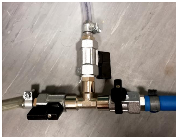
Σχήμα 11: Εξάρτημα για πολλαπλές συνδέσεις σωλήνων με τρεις ρυθμιστικές βάνες
