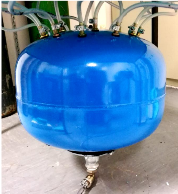
Σχήμα 8: Δοχείο διαστολής χωρητικότητας 24 lt προ του κυτίου από plexiglass
