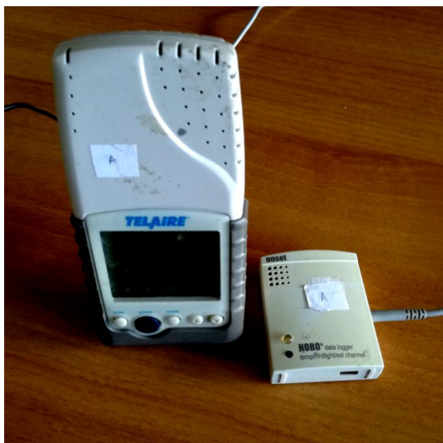
Σχήμα 6: Αισθητήρας Telaire T7000 μαζί με τον καταγραφέα δεδομένων τύπου HOBO
