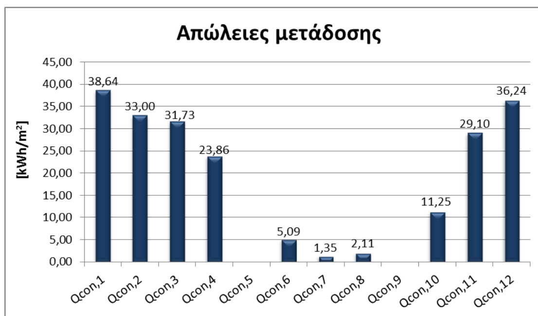
Σχήμα 6.8: Μηνιαία αποτελέσματα ενεργειακών απωλειών μετάδοσης συνολικά, ανά συνολική ακαθάριστη επιφάνεια, σε kWh/m 2 .
