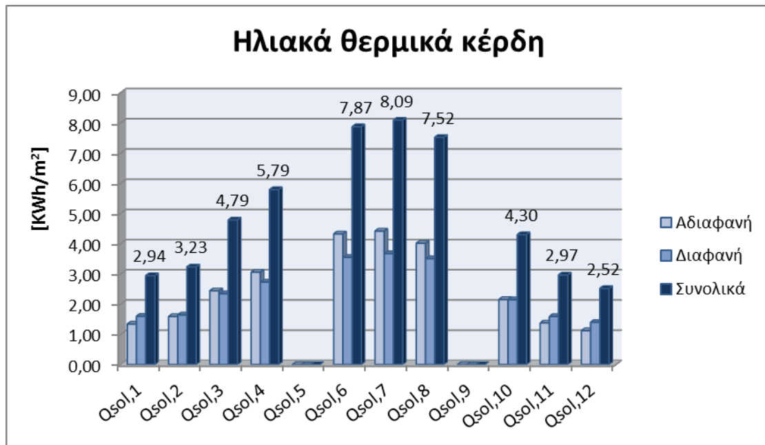
Σχήμα 6.5: Μηνιαία αποτελέσματα θερμικών ηλιακών κερδών για αδιαφανή, διαφανή και συνολικά δομικά στοιχεία, ανά συνολική ακαθάριστη επιφάνεια, σε kWh/m^2 .
