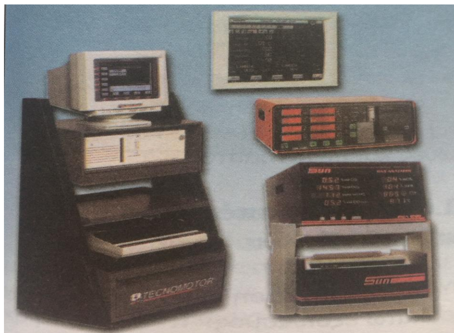
Εικόνα 37: Αναλυτές καυσαερίων πέντε αερίων με εκτυπωτές (κάτω)
