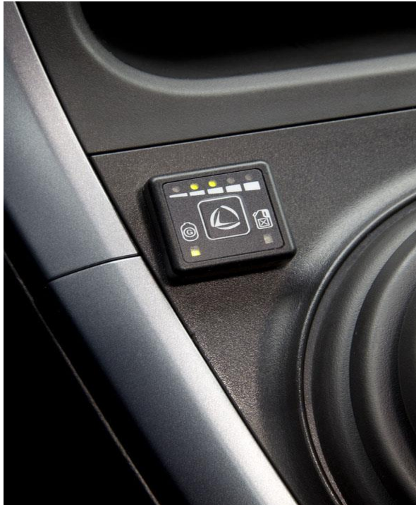
Εικόνα 41: Αισθητήρας εναλλαγής βενζίνης-υγραερίου
