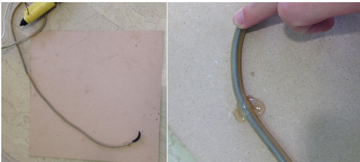
Σχήμα 6.2: Επικόλληση της πηγής θερμότητας με τη βοήθεια πιστολιού σιλικόνης.
