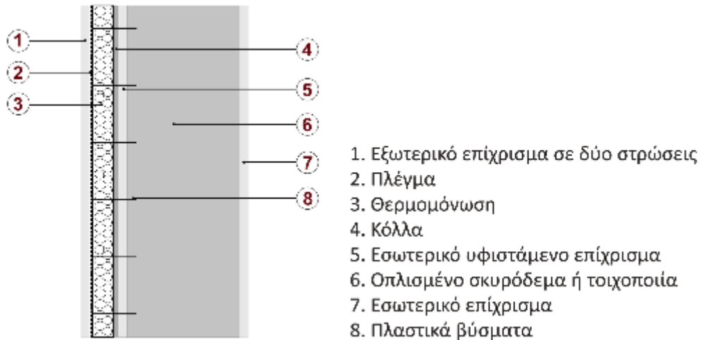
Σχήμα 3.4: Εξωτερική θερμομόνωση τοίχου με μονωτικό υλικό [www.epshellas.com]
