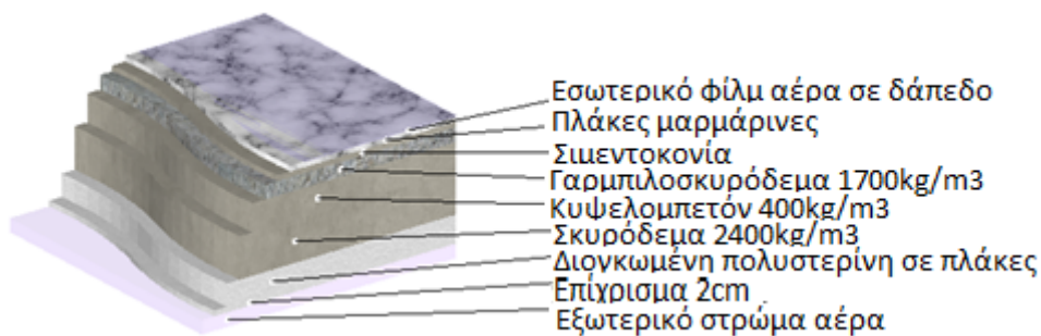
Σχήμα 7.30: Επιλογή δαπέδου τύπου PILOTIS με διογκωμένη πολυστερίνη. (ανάλυση: διαστάσεις, συντελεστής θερμοπερατότητας/ σχηματική απεικόνιση)
