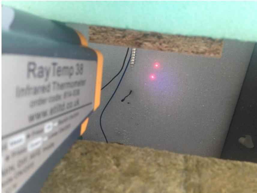
Σχήμα 6.13: Μέτρηση θερμοκρασίας εσωτερικής επιφάνειας της διογκωμένης πολυστερίνης κατά την διεξαγωγή του πειράματος
