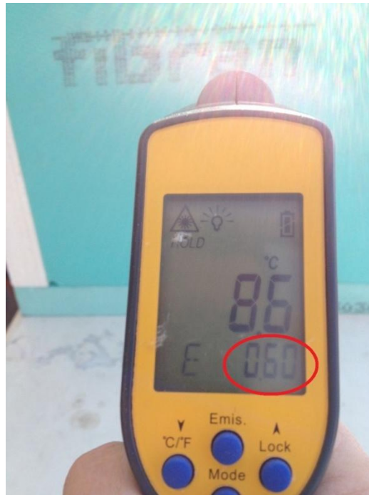
Σχήμα 6.11: Μέτρηση θερμοκρασίας εξωτερικής επιφάνειας της αφρώδους εξηλασμένης πολυστερίνης κατά την διεξαγωγή του πειράματος
