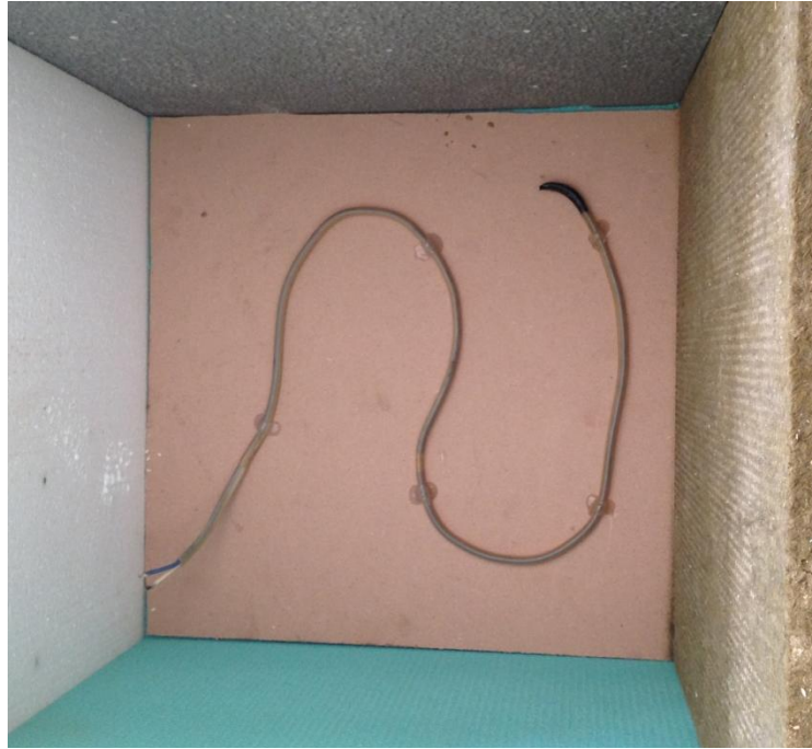
Σχήμα 6.4: Τοποθέτηση πηγής θερμότητας στο δοκίμιο
