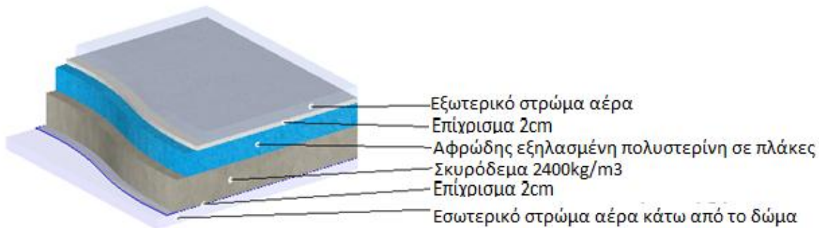
Σχήμα 7.41: Επιλογή οροφής με αφρώδη εξηλασμένη πολυστερίνη. (ανάλυση: διαστάσεις, συντελεστής θερμοπερατότητας/ σχηματική απεικόνιση)
