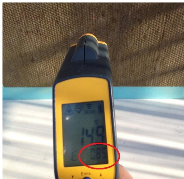
Σχήμα 6.12: Μέτρηση θερμοκρασίας εξωτερικής επιφάνειας του πετροβάμβακα κατά την διεξαγωγή του πειράματος
