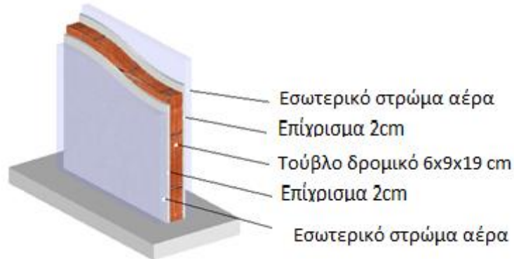
Σχήμα 7.6: Επιλογή εσωτερικής τοιχοποιίας (ανάλυση: διαστάσεις, συντελεστής θερμοπερατότητας/ σχηματική απεικόνιση)
