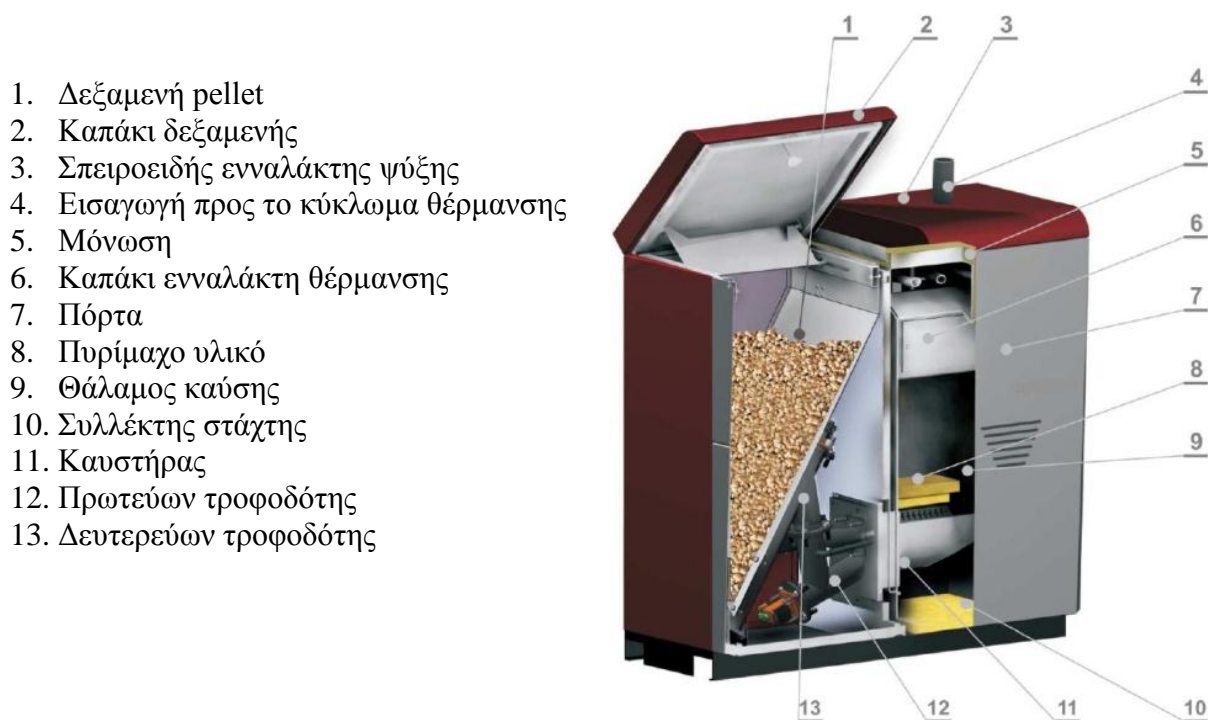
Εικόνα 2.26 Μέρη καυστήρα πέλλετ
