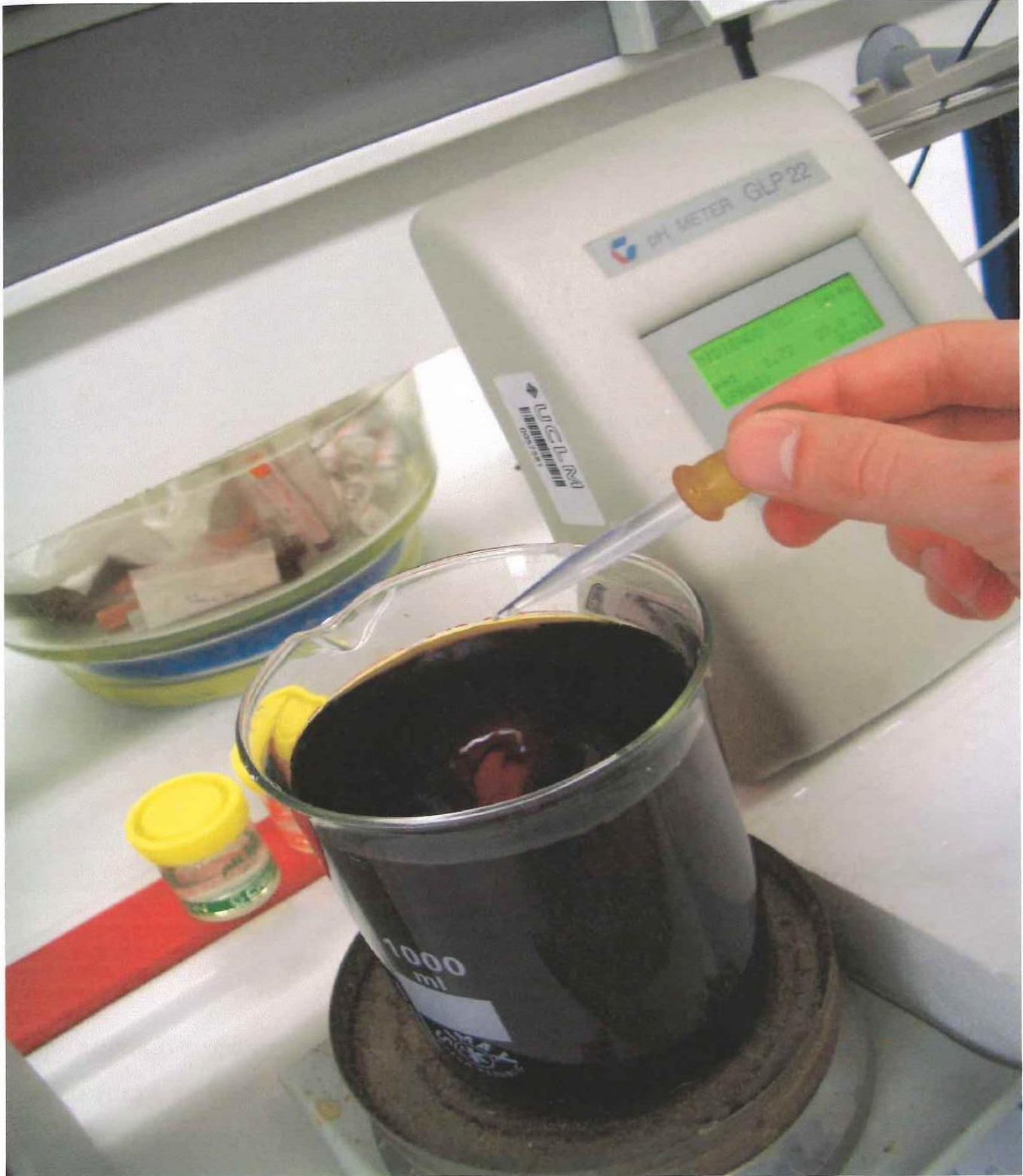
φωτογραφία 3. σταγόνα – σταγόνα υδροχλωρικό οξύ ( \text{HCl} , 5 M).
