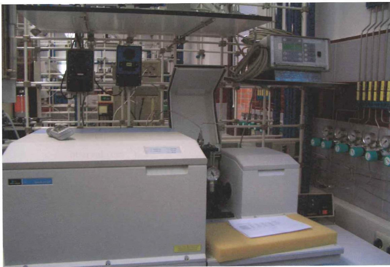
φωτογραφία 13. Χρωματογράφος PERKIN ELMER, model Spectrum GX/GXR.
