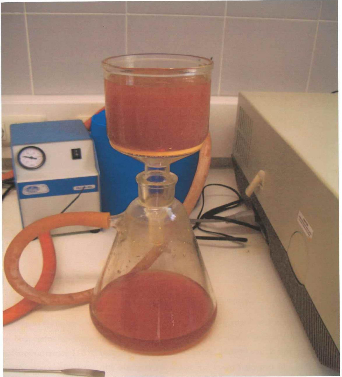
φωτογραφία 7. Διαδικασία καθαρισμού του διαλύματος .
