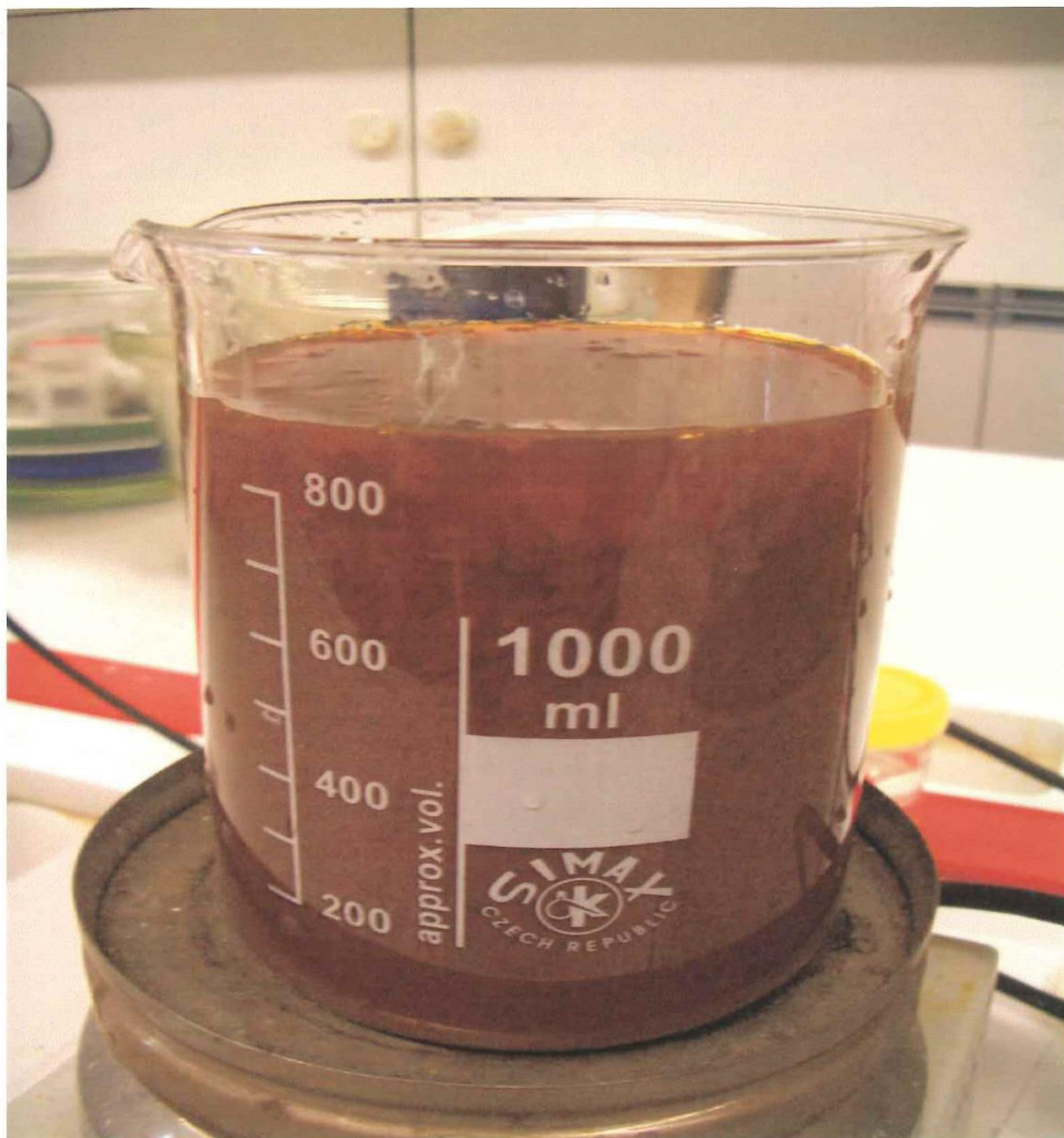
φωτογραφία 2. \text{NaOH} + \text{FeCl}_3 \cdot 6\text{H}_2\text{O} .
