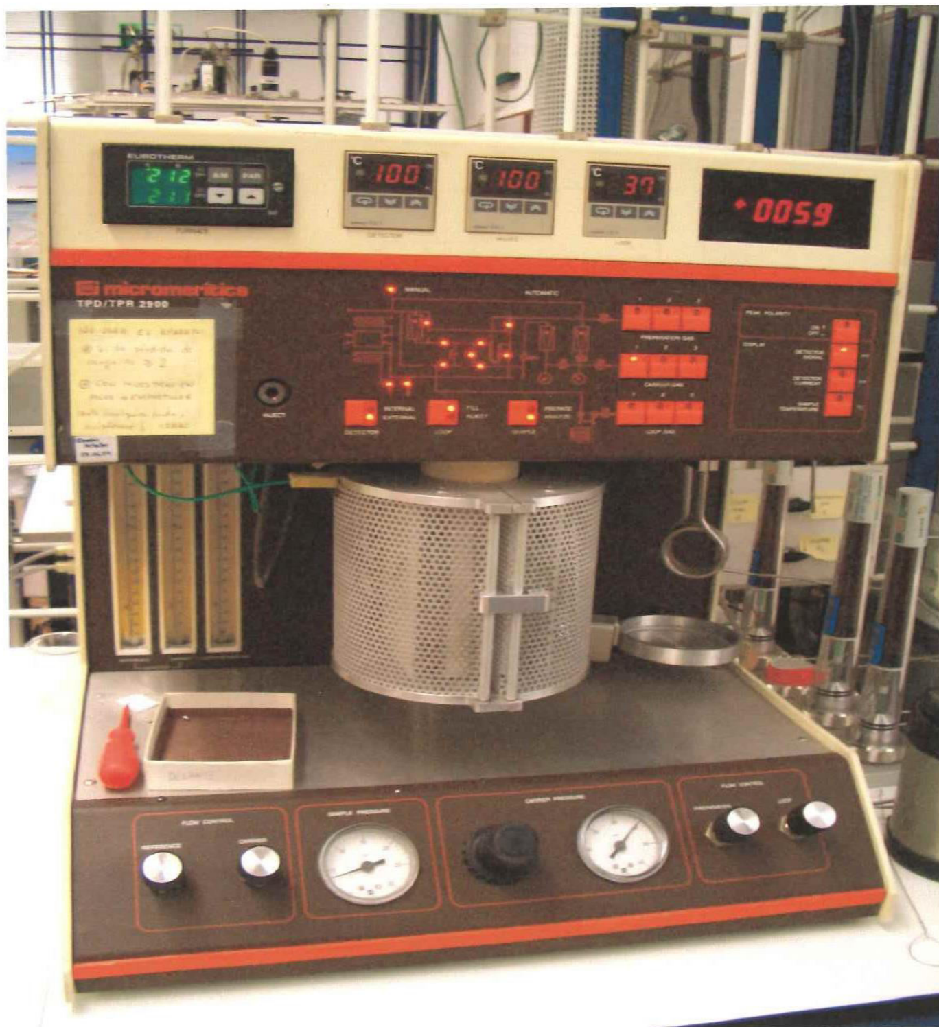
φωτογραφία 14. πειραματική συσκευή micromeritics TPR/TPD 2900.
