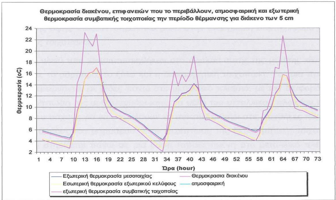
Διάγραμμα 4.18. Θερμοκρασία διακένου, επιφανειών που το περιβάλλουν, ατμοσφαιρική και εξωτερική θερμοκρασία συμβατικής τοιχοποιίας την περίοδο θέρμανσης
