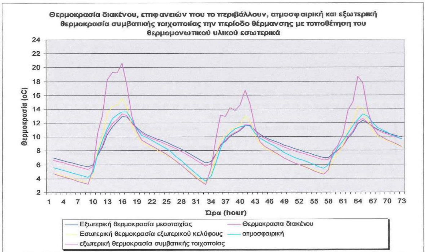
Διάγραμμα 4.32. Θερμοκρασία διακένου, επιφανειών που το περιβάλλουν, ατμοσφαιρική και εξωτερική θερμοκρασία συμβατικής τοιχοποιίας την περίοδο θέρμανσης με τοποθέτηση του θερμομονωτικού υλικού εσωτερικά
