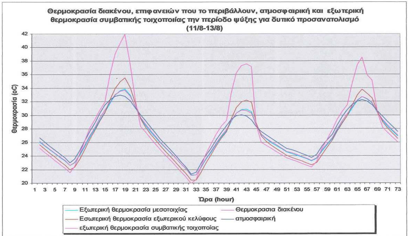
Διάγραμμα 4.13. Θερμοκρασία διακένου, επιφανειών που το περιβάλλουν, ατμοσφαιρική και εξωτερική θερμοκρασία συμβατικής τοιχοποιίας την περίοδο ψύξης για δυτικό προσανατολισμό
