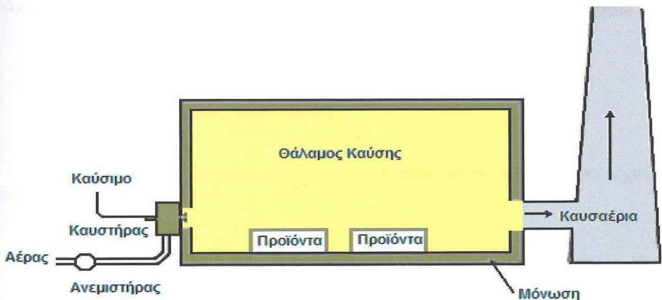
Σχήμα 1. Απεικόνιση φούρνου με φυσικό ελκυσμό
