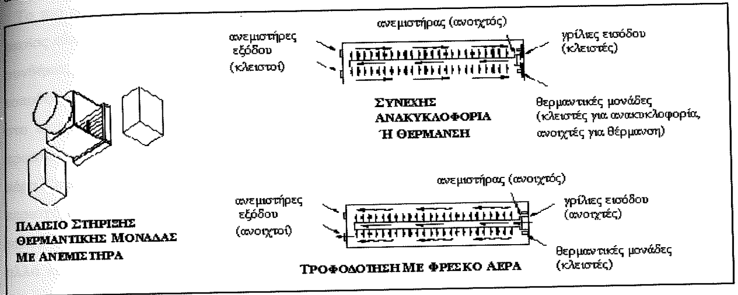
Σχήμα 5.6: Απεικόνιση συστήματος πολλαπλών αγωγών, υποκινούμενου από ανεμιστήρα. (Buffington et al.)
