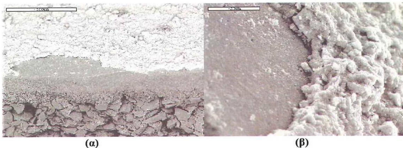
Σχήμα 4.4: Φωτογραφίες από SEM (α) Τομή μιας μεμβράνης διάλυμα – πήκτης η οποία αποτελείται από 98% σίδηρο και 2% αλούμινα και (β) μεγένθυση της φωτογραφίας (α) στην οποία φαίνεται το πάχος του στρώματος σιδήρου που έχει εναποτεθεί στην εσωτερική επιφάνεια της μεμβράνης (δεξιά της φωτογραφίας).
