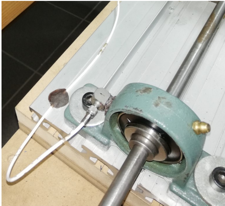
Σχήμα 5.2: Θέση επιταχυνσιόμετρου στο πρώτο έδρανο (αριστερά)
