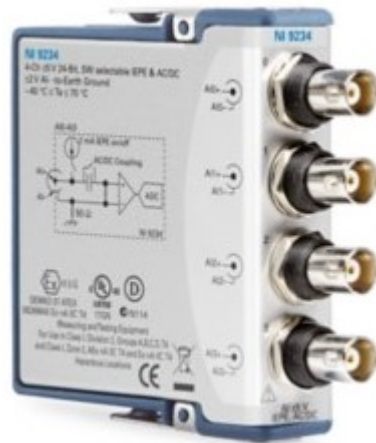
Σχήμα 5.6: Μονάδα εισαγωγής δεδομένων NI 9234 (πηγή: http://www.ni.com/en-us/support/model.ni-9234.html )
