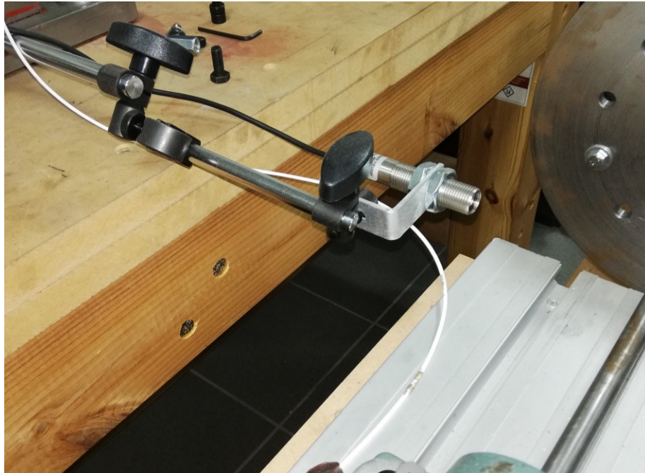
Σχήμα 5.4: Θέση οπτικού αισθητήρα στην πειραματική διάταξη
