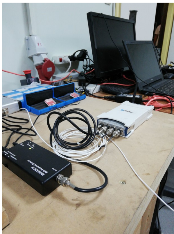
Σχήμα 4.6: Σύστημα λήψης δεδομένων σε πραγματικό χρόνο
