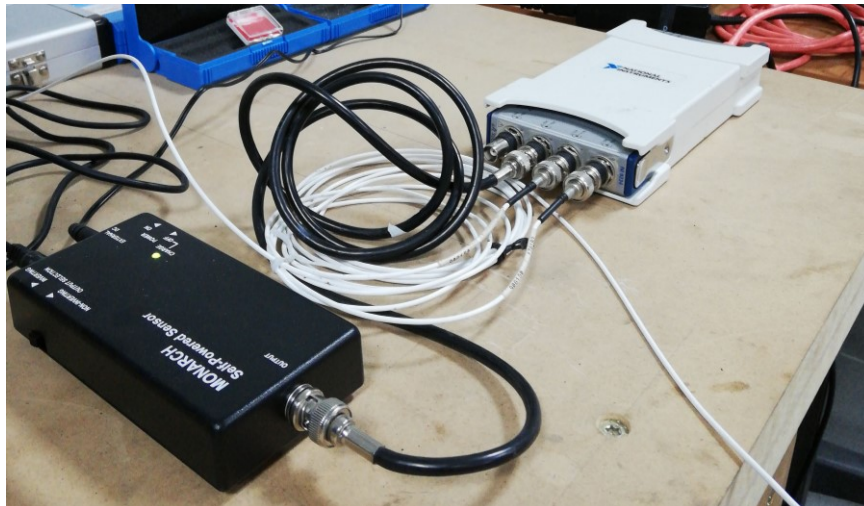
Σχήμα 5.5: Κεντρική μονάδα διασύνδεσης για καταγραφή ταχύτητας περιστροφής, Monarch
