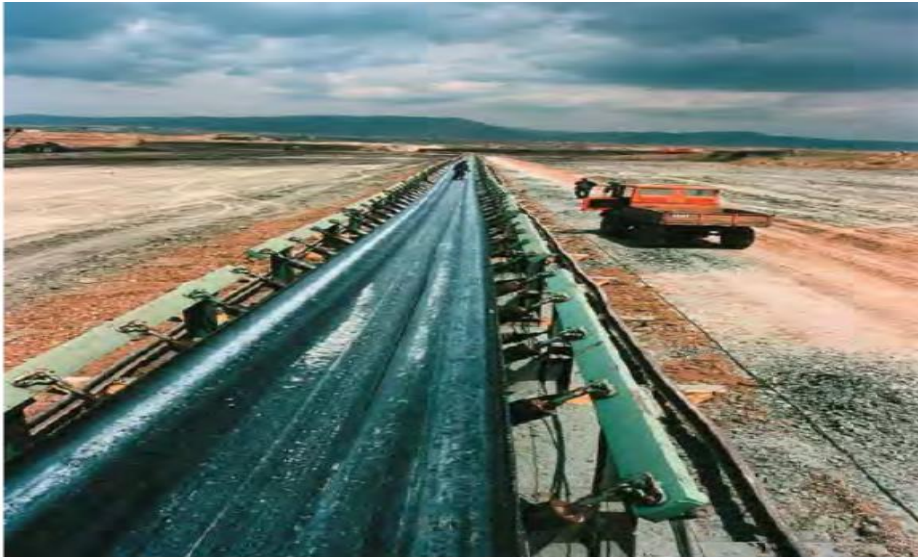
Εικόνα 14: Εξόρυξη του λιγνίτη και μεταφορά του με ταινιόδρομο στο ορυχείο Νοτίου Πεδίου του ΛΚΔΜ [4]
