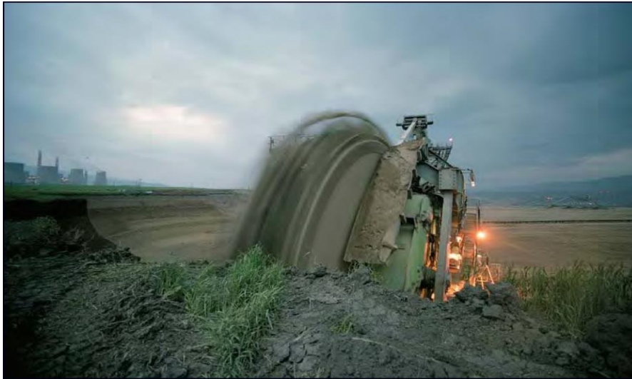
Εικόνα 15: Ο καδοφόρος εκσκαφέας απομακρύνει το χώμα για να αποκαλύψει το λιγνιτικό κοίτασμα στο ορυχείο καρδιάς στο λιγνιτικό κέντρο Πτολεμαΐδας [4]
