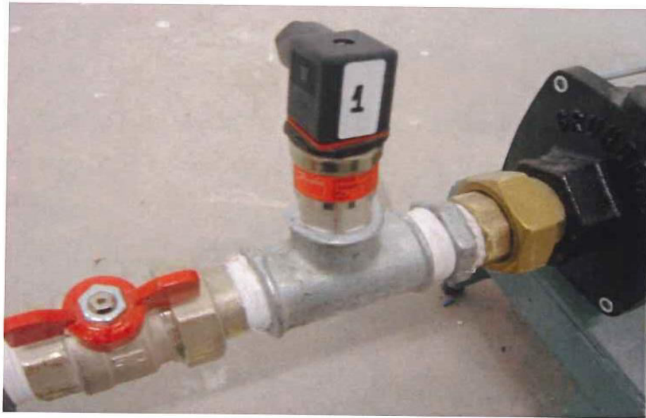
Εικόνα 4: Μεταδότης πίεσης DANFOSS MBS-3000 πριν την αντλία
