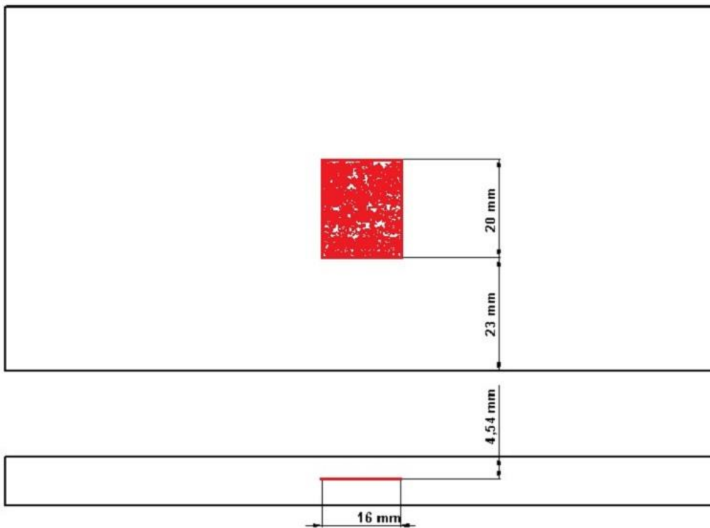
Σχήμα 6.30: Σκαρίφημα μεταλλικής πλάκας και αναπαράσταση ασυνέχειας lamination
