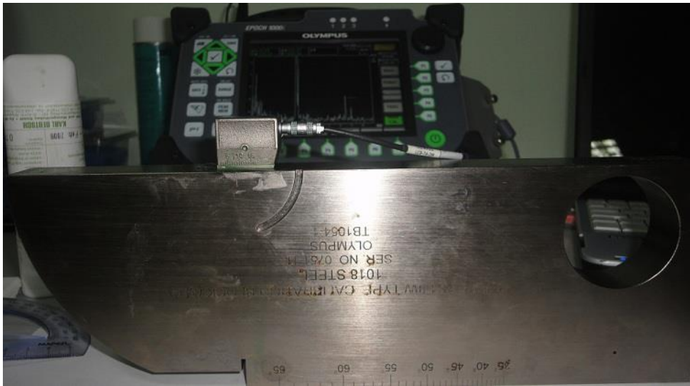
Σχήμα 6.17: Εύρεση σημείου BIP στο δοκίμιο V1 για γωνιακή κεφαλή 70°
