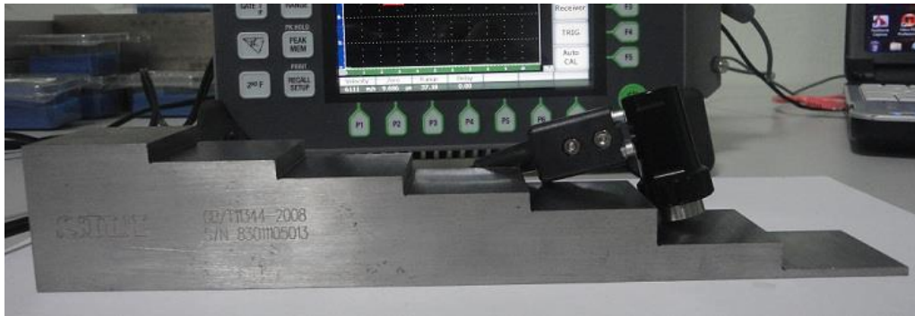
Σχήμα 6.21: Κλιμακωτή πλάκα βαθμονόμησης 7 επιπέδων
