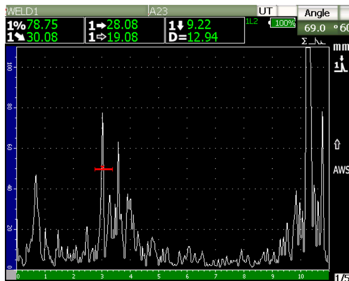
Σχήμα 6.51: Στιγμιότυπο σήματος σε μισή βηματική απόσταση για την συγκόλληση για την συγκόλληση 6
