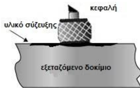
Σχήμα 4.13: Υλικό σύζευξης μεταξύ κεφαλής – δοκιμίου
