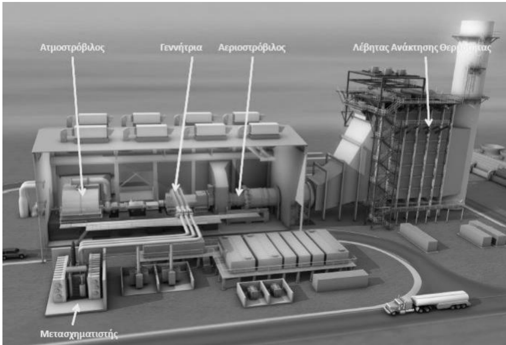
Εικόνα 19: Γενική Διάταξη Εξοπλισμού Σταθμού Συνδυασμένου Κύκλου [36]
