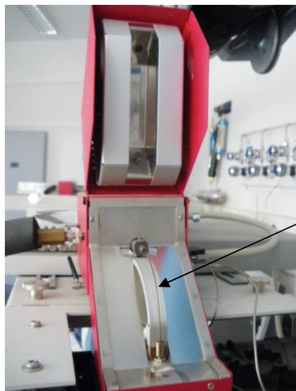
Σχήμα 7.22: Σύστημα θερμικής εκρόφησης (ThermoDesorption System), GERSTEL TDS.
