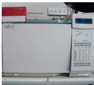
Σχήμα 7.26: Θάλαμος θέρμανσης της τριχοειδούς στήλης (εξωτερικά-εσωτερικά), Agilent Technologies 6890N.
