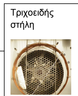
Σχήμα 7.26: Θάλαμος θέρμανσης της τριχοειδούς στήλης (εξωτερικά-εσωτερικά), Agilent Technologies 6890N.
