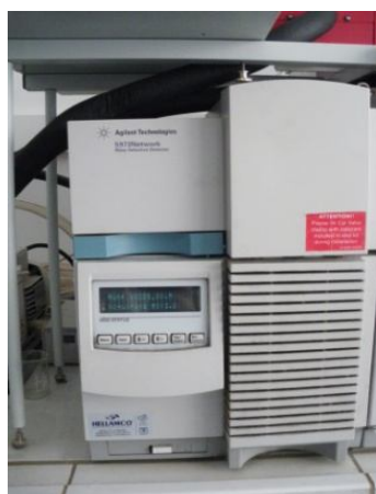
Σχήμα 7.27: Φασματογράφος μάζας, Agilent Technologies 62579A.
