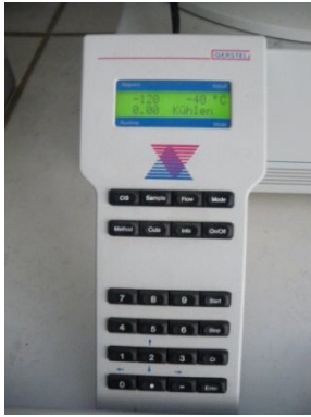
Σχήμα 7.23: Ρυθμιστής θερμοκρασίας για το σύστημα TDS και κρυοπαγίδας.
