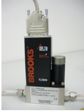
Σχήμα 7.5: Mass flow controller (έλεγχος ροής του αέρα που διαβιβάζεται στο CLIMPAQ) DELTA BROOKS® (αριστερά), ρυθμιστής του mass flow controller (δεξιά).
