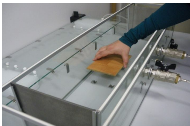
Σχήμα 7.14: Εισαγωγή δείγματος δοκιμής στο θάλαμο CLIMPAQ.
