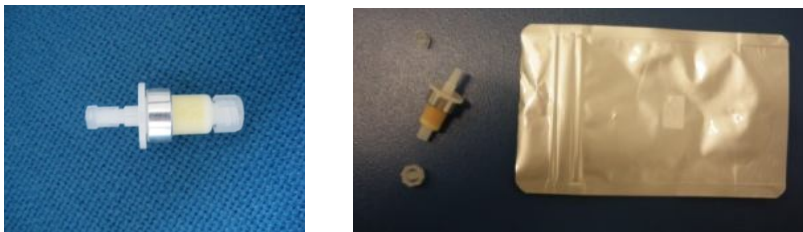
Σχήμα 7.9: Φυσίγγια δειγματοληψίας καρβονυλικών ενώσεων 2,4 δινιτροφαιλυδραζίνη (DNPH).
