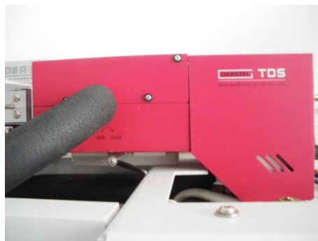
Σχήμα 7.22: Σύστημα θερμικής εκρόφησης (ThermoDesorption System), GERSTEL TDS.
