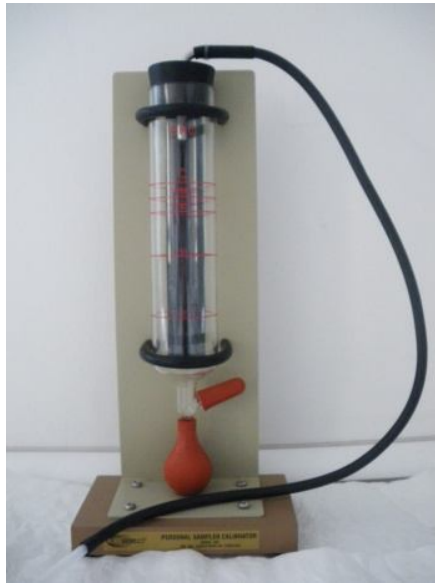
Σχήμα 7.11: Ροόμετρο φισαλίδας, Model 303 SKC®.
