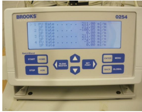
Σχήμα 7.5: Mass flow controller (έλεγχος ροής του αέρα που διαβιβάζεται στο CLIMPAQ) DELTA BROOKS® (αριστερά), ρυθμιστής του mass flow controller (δεξιά).
