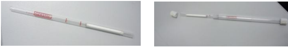
Σχήμα 7.8: Σωληνάκια δειγματοληψίας VOC με προσροφητικό υλικό Tenax TA®.
