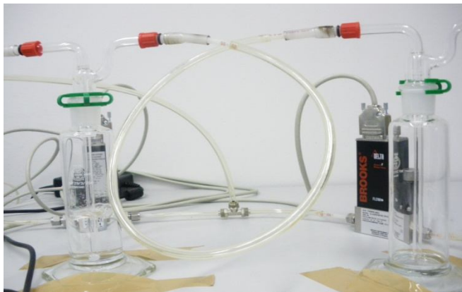
Σχήμα 7.6: Ρύθμιση της σχετικής υγρασίας του αέρα στο 50%.
