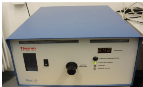
Σχήμα 7.4: Γεννήτρια παροχής μηδενικού αέρα (Zero Air Supply), Thermo SCIENTIFIC Model 1160 (αριστερά), παγίδα που συγκρατεί υδρογονάνθρακες (δεξιά).
