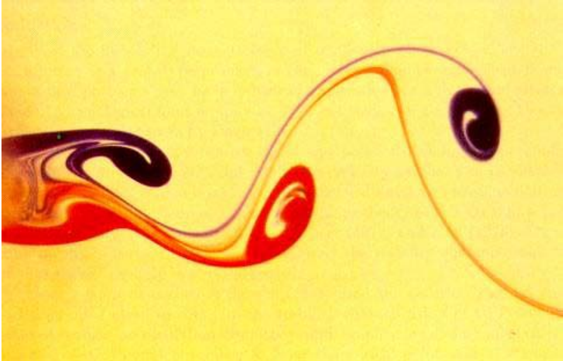
Σχήμα 2: Η οδός στροβίλων von Kármán. Για την οπτικοποίηση χρησιμοποιήθηκε η μέθοδος χρωματισμού του ρευστού. Μάλιστα χρησιμοποιήθηκαν δύο διαφορετικά χρώματα για την καλύτερη οπτικοποίηση των φαινομένων μεταφοράς μάζας (Perry et al., 1982).
