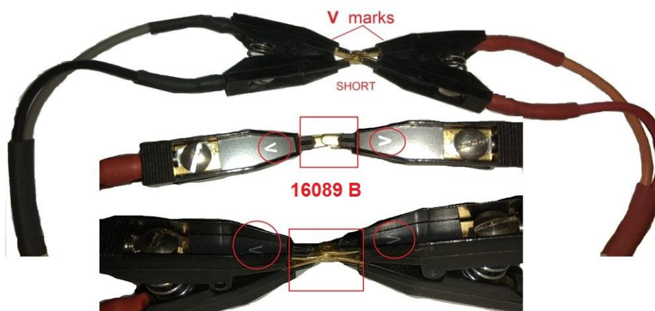
Εικόνα 12: Ακροδέκτης 16089B σε θέση ΚΛΕΙΣΤΟ (SHORT)
