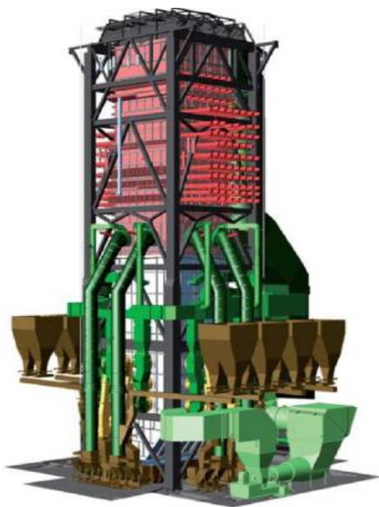
Εικόνα 5: Λέβητας σύγχρονης λιγνιτικής μονάδας
