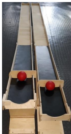
Εικόνα 15: Μεταβλητή υπό έλεγχο η κλίση της ράμπας
