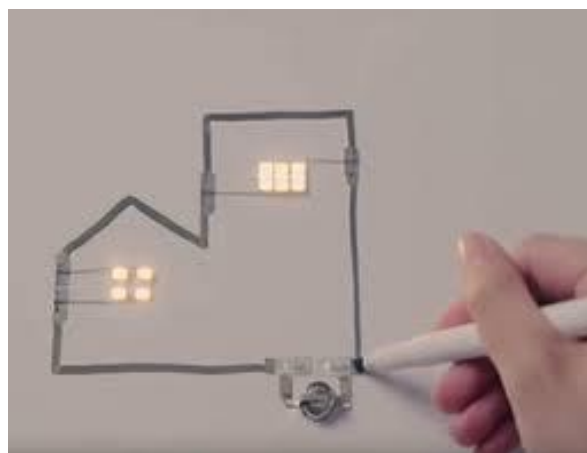
Εικόνα 11: Απεικόνιση Κυκλώματος σε μορφή σπιτιού, https://www.electronicsspecifier.com/around-the-industry/marker-pen-enables-you-to-draw-an-electric-circuit .
