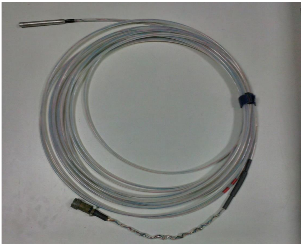
Σχήμα 24: Κεφαλή ελέγχου RFT μαζί με καλώδιο ελέγχου για τη σύνδεση με το όργανο
