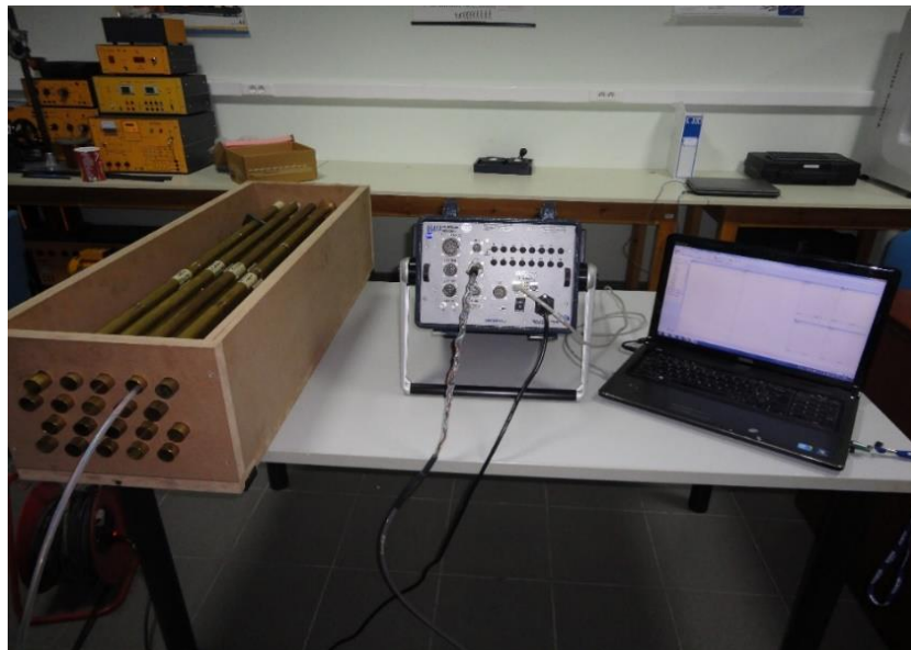
Σχήμα 55: Διάταξη ελέγχου εναλλάκτη με ECT
