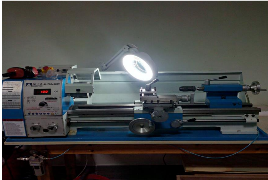
Σχήμα 27: Διάταξη τόρνου ALFA MACHINERY-TOOLS AL700X280V
