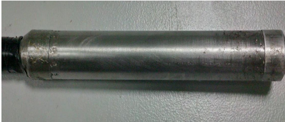
Σχήμα 23: Κεφαλή μονής διέγερσης για εσωτερικό έλεγχο σωληνώσεων σιδηρομαγνητικού υλικού
