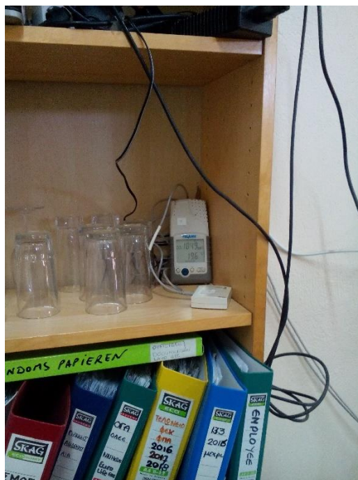
Εικόνα 4.3 Όψη μηχανημάτων για μέτρηση CO 2 και θερμοκρασίας-υγρασίας
