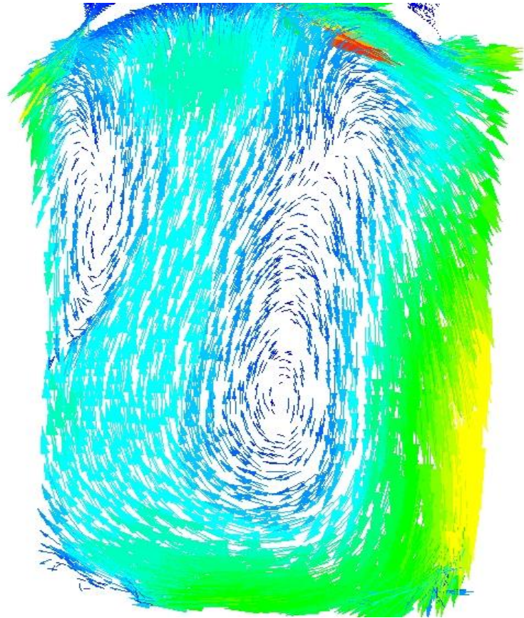
Εικόνα 59 - Μέσο πεδίο ταχυτήτων στις 540° για 1000 rpm (0.5 bar)
