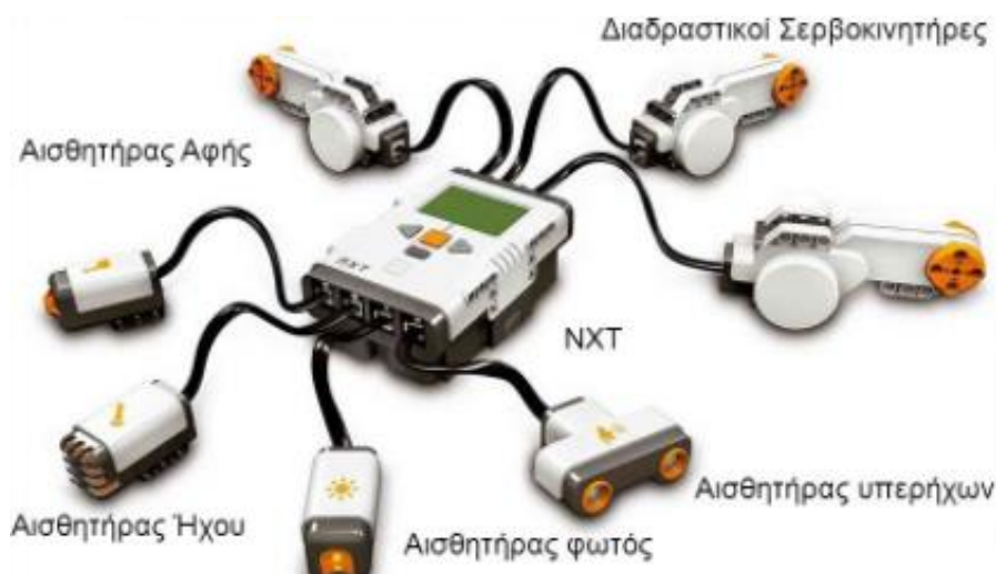
Εικόνα 12 Βασικά μέρη που αποτελούν το πακέτο Lego Mindstorm NXT
