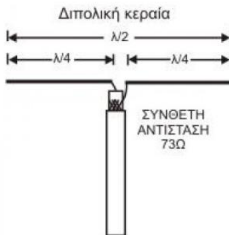
Εικόνα 5.1 : Δίπολο \lambda/2 (πηγή www.psarema-skafos.gr ).
