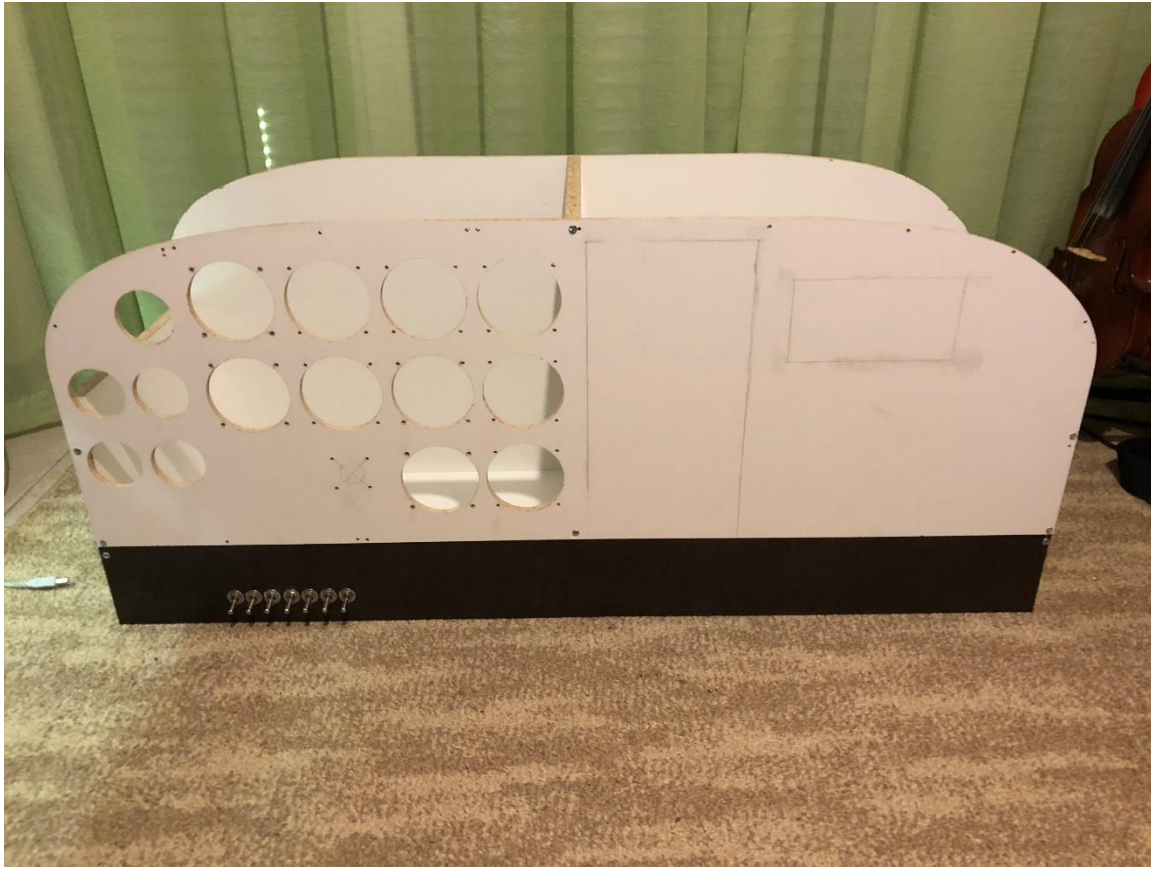
Εικόνα 5.2: Το πλαίσιο του εξομοιωτή με έτοιμες τις θέσεις των οργάνων.
