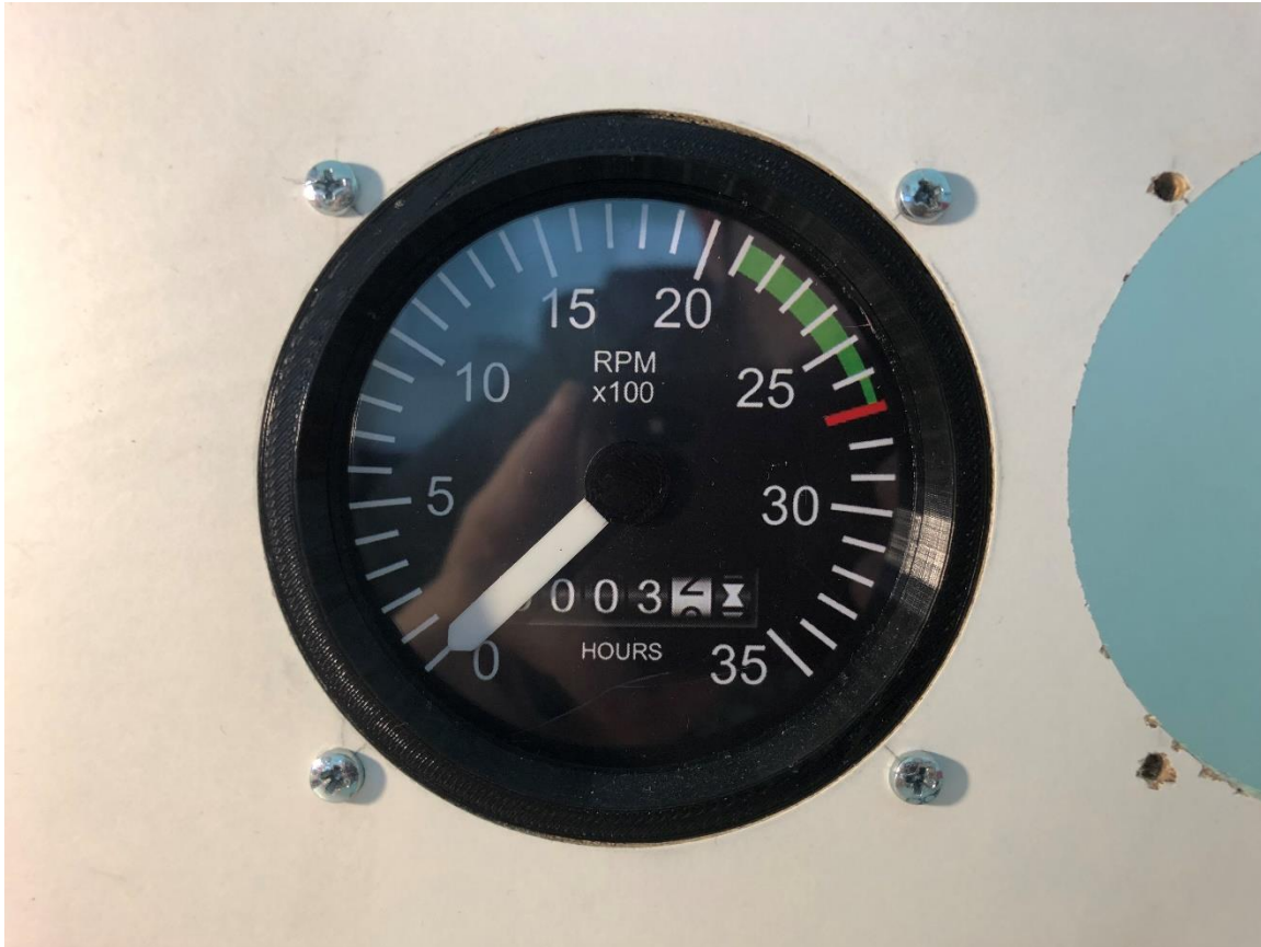
Εικόνα 5.7: Ολοκληρωμένη μορφή του οργάνου μέτρησης των στροφών του κινητήρα.
