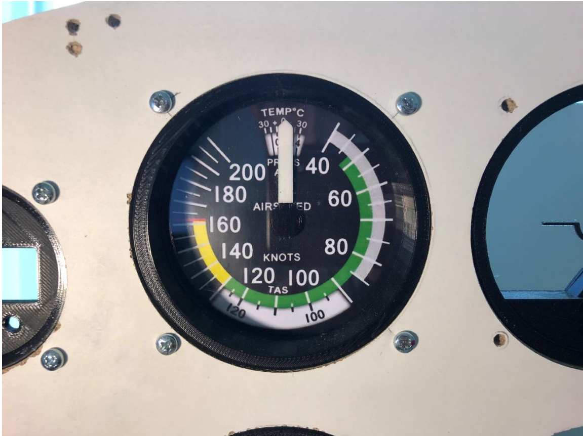
Εικόνα 5.5: Ολοκληρωμένη μορφή του οργάνου μέτρησης της ταχύτητας πλεύσης.
