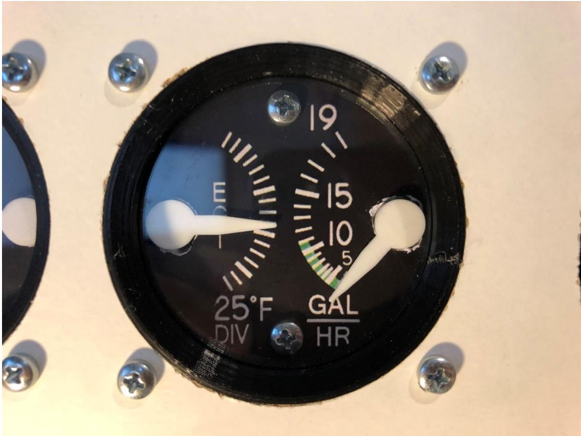
Εικόνα 5.19: Ολοκληρωμένη μορφή του οργάνου μέτρησης της θερμοκρασίας των καυσαερίων και της κατανάλωσης του καυσίμου.
