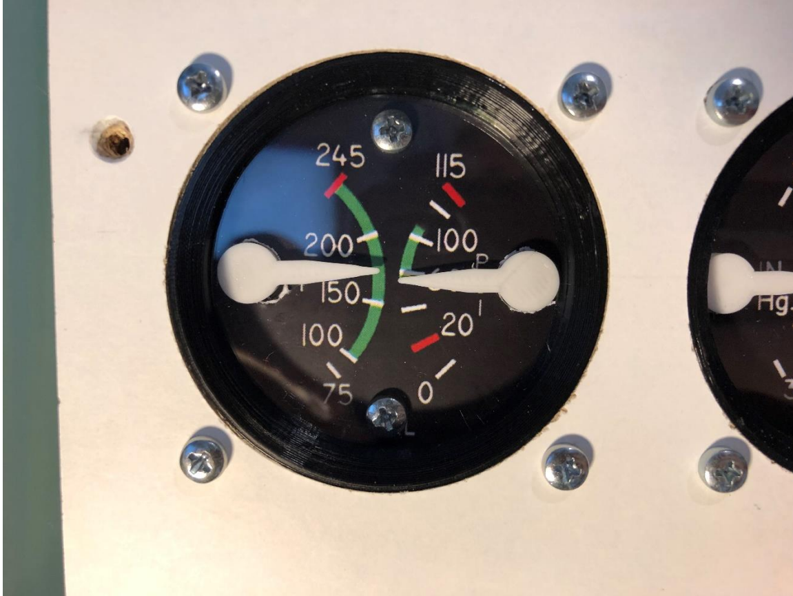
Εικόνα 5.18: Ολοκληρωμένη μορφή του οργάνου μέτρησης της θερμοκρασίας και της πίεσης του λαδιού του κινητήρα.
