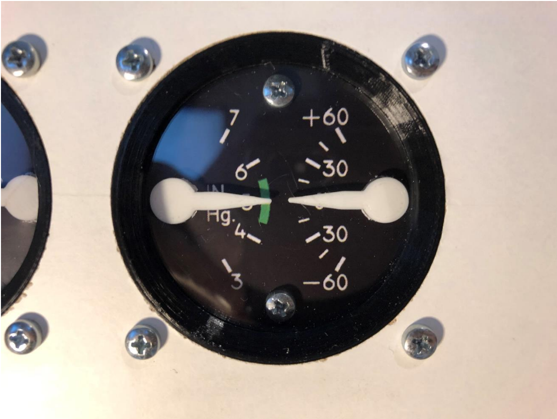
Εικόνα 5.20: Ολοκληρωμένη μορφή του οργάνου μέτρησης κενού και του ρεύματος του ηλεκτρικού συστήματος.
