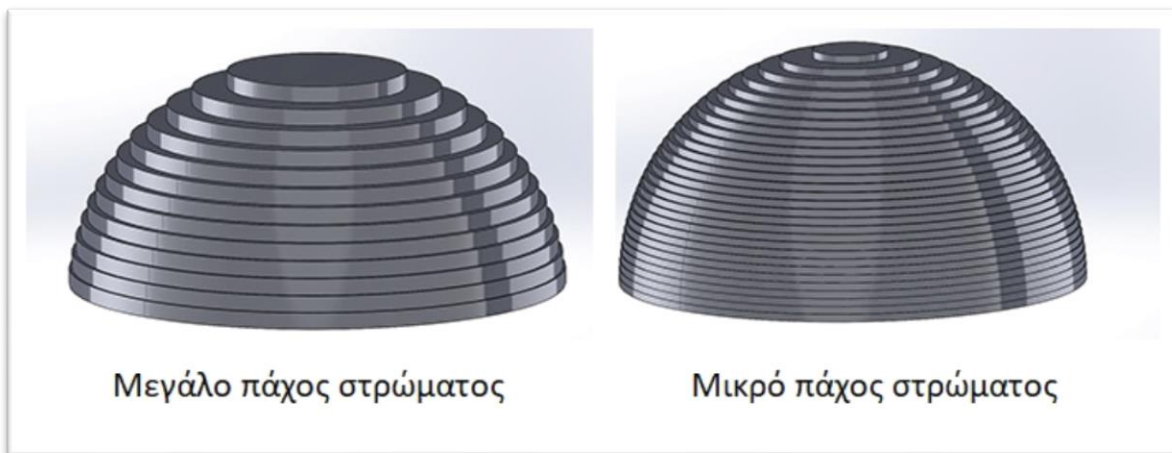
Εικόνα 3.7: Επίδραση του πάχους στρώματος στην επιφάνεια των αντικειμένων [42].
