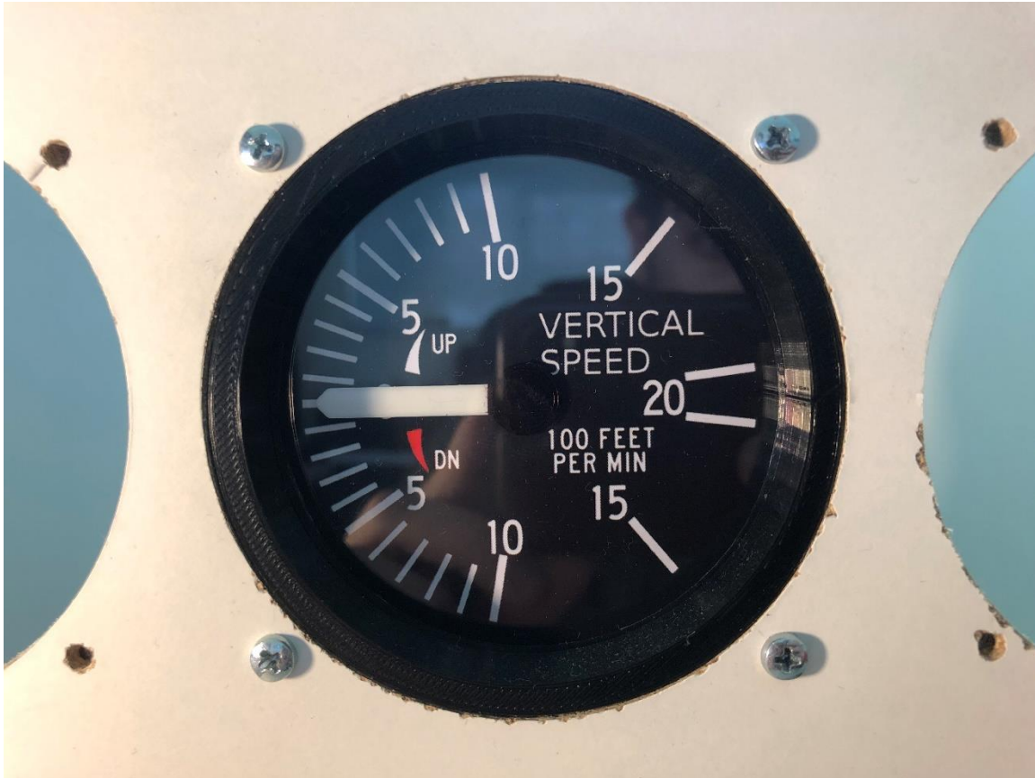
Εικόνα 5.6: Ολοκληρωμένη μορφή του οργάνου μέτρησης της κάθετης ταχύτητας.
