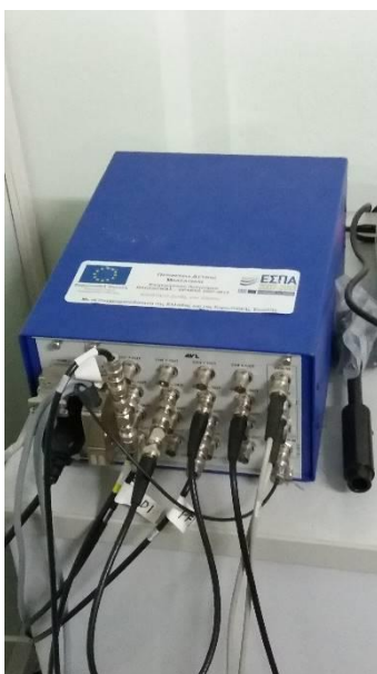
Εικόνα 2.10 – Μονάδα χρονισμού της πειραματικής μηχανής
