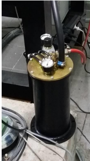
Εικόνα 3.9 – Ο τροφοδότης σωματιδίων (seeder) της PIVTEC GmbH
