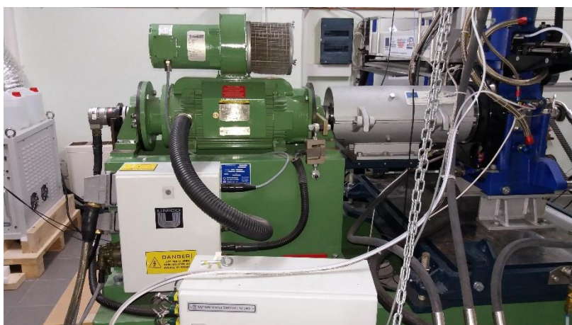
Εικόνα 2.8 – Η διάταξη του δυναμόμετρου της DSG
