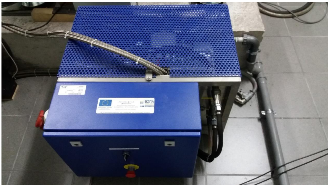
Εικόνα 2.7 – Η αντλία του συστήματος άμεσου ψεκασμού καυσίμου
