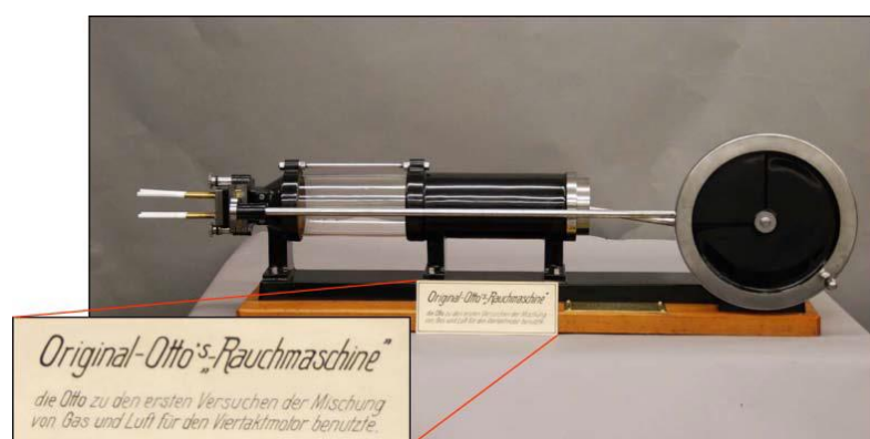
Εικόνα 2.1 – Ο οπτικός κινητήρας του Otto το 1872, πηγή: [13]
