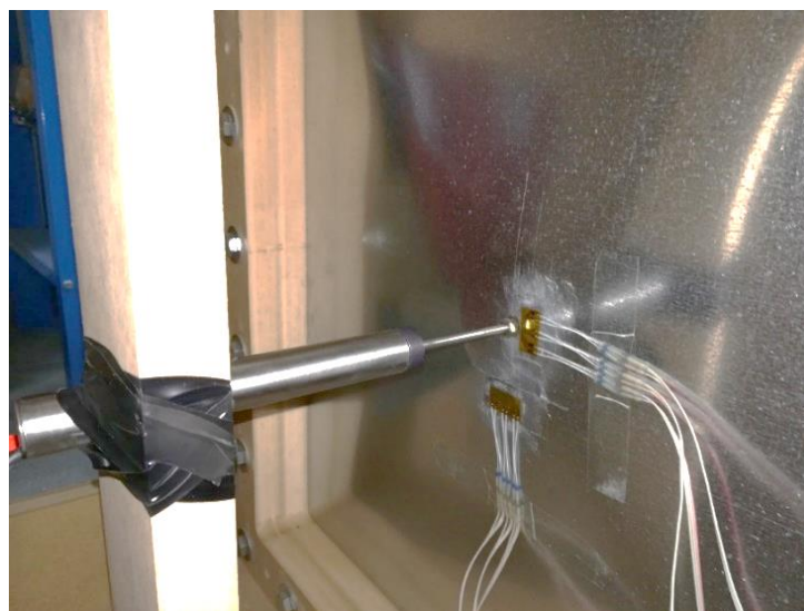
Σχήμα 2.7 Εφαρμογή strain gages σε δύο σημεία του δοκιμίου
