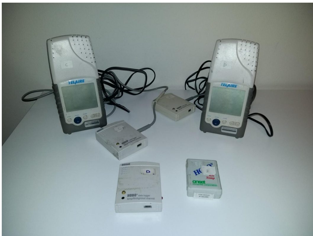
Εικόνα 3.24: Οι αισθητήρες HOBO και οι συσκευές TELAIRE
