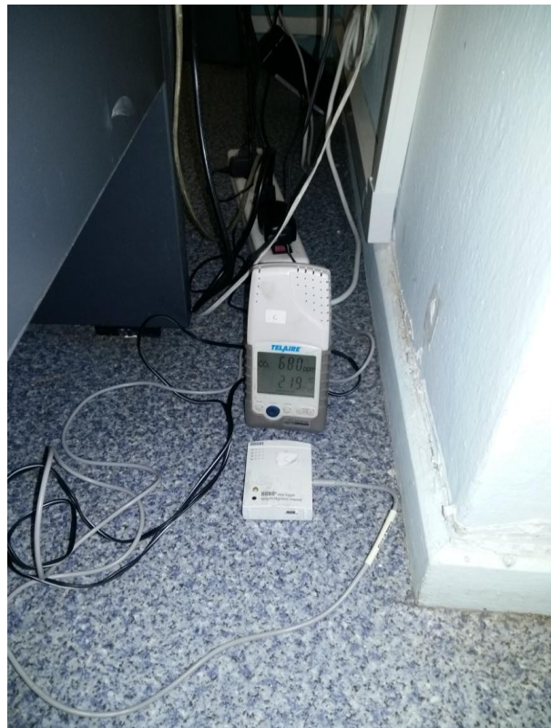
Εικόνα 3.26: Ο αισθητήρας HOBO C και η συσκευή TELLAIRE C εσωτερικά του πρώτου ορόφου
