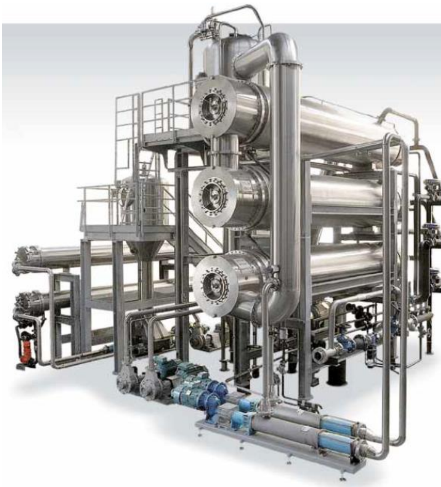
Σχημ.4: Σύστημα ELDORADO (Εναλλάκτης θερμότητας) για την αδρανοποίηση των ενζύμων με τη μέθοδο HOT BREAK [Πηγή: Φωτογραφικό αρχείο εξοπλισμού Δ. ΝΟΜΙΚΟΣ Α.Ε.]
