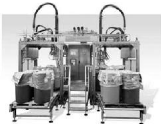
Σχημ.8: Ασηπτικό γεμίσματος βαρελιών [Πηγή: Φωτογραφικό αρχείο εξοπλισμού Δ. ΝΟΜΙΚΟΣ Α.Ε.]
