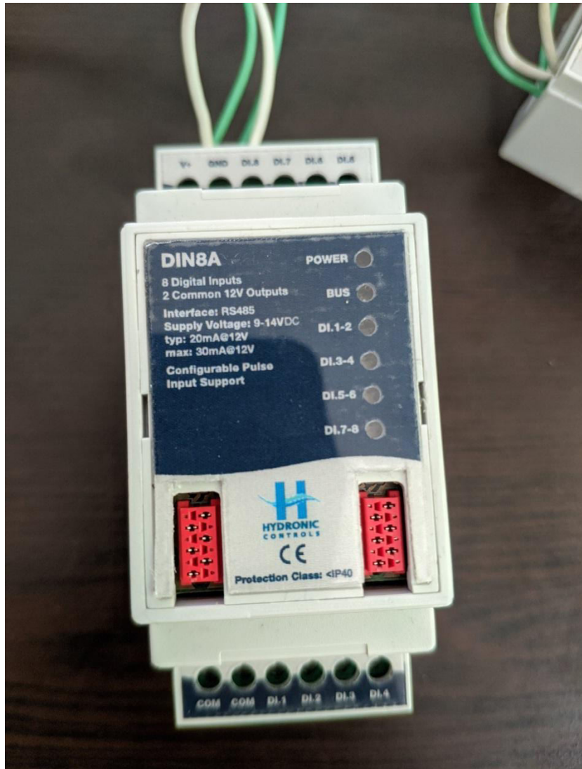
Εικόνα 5.3. Μονάδα ψηφιακής εισαγωγής DIN8A με ενσωματωμένες 8 ψηφιακές εισόδους
