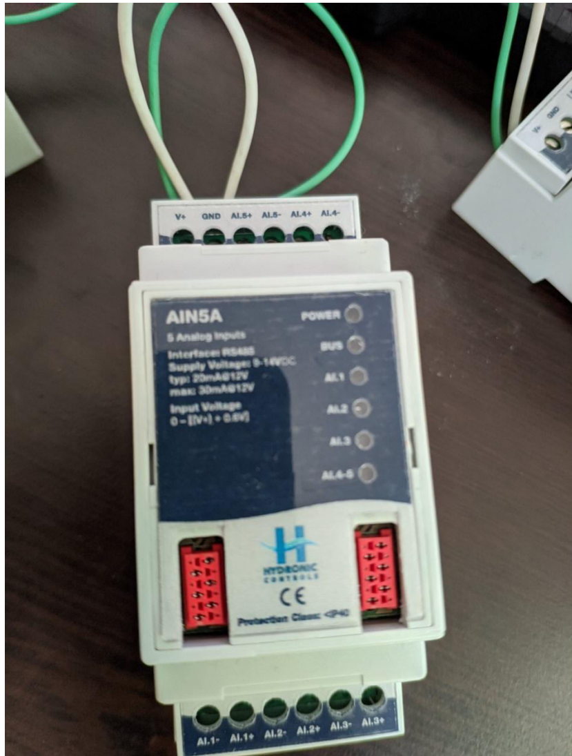
Εικόνα 5.4. Μονάδα αναλογικής εισαγωγής AIN5A με ενσωματωμένες 5 αναλογικές εισόδους
