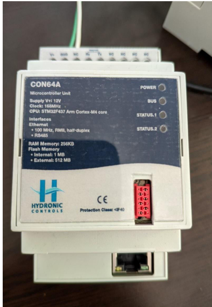
Εικόνα 5.2. Υψηλής ισχύος προγραμματιζόμενος λογικός controller CON64A, σχεδιασμένος για μικρές και μεσαίες εγκαταστάσεις.
