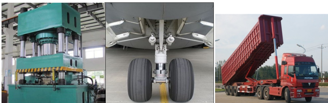
Εικόνα 3.3 Εφαρμογές υδραυλικών εμβόλων α) σε υδραυλική πρέσα {12}, β) σε σύστημα προσγείωσης αεροπλάνου {13} και γ) σε σύστημα ανύψωσης καρότσας φορτηγού οχήματος {14}.
