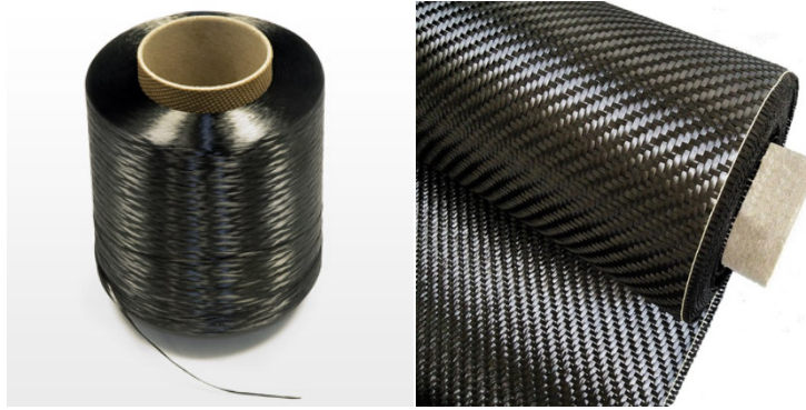
Εικόνα 2.4 Νήμα (Tow/Roving) (αριστερά) {4} και ύφασμα (Fabric) (δεξιά) άνθρακα {5}.
