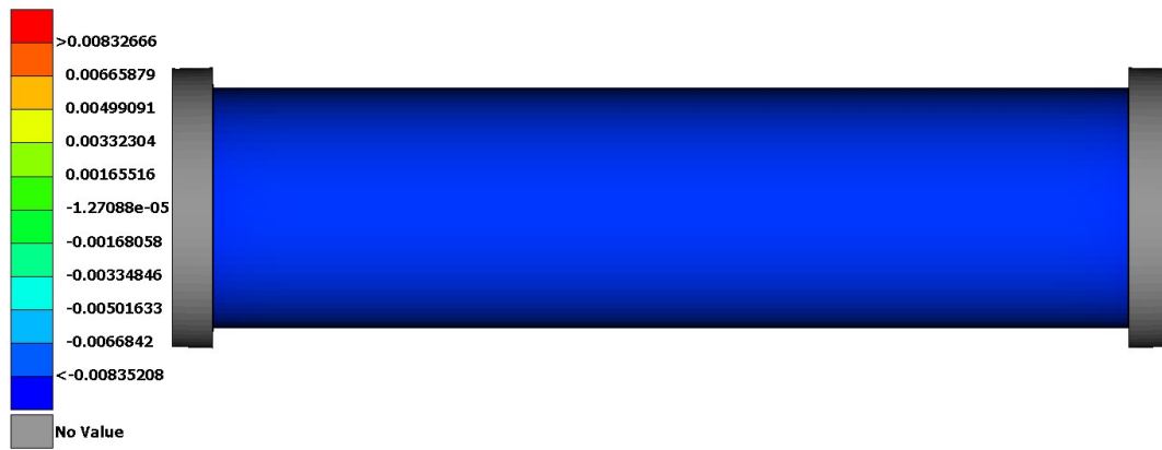
Εικόνα 5.10 Διατμητικές τροπές στο επίπεδο 12 (Shear-12) εμβόλου σύσφιξης με ράβδους σε πίεση 400 bar
