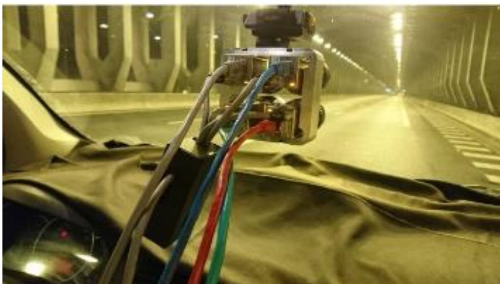
Σχήμα 13.5: Συσκευή ILMD, επί τω έργω
