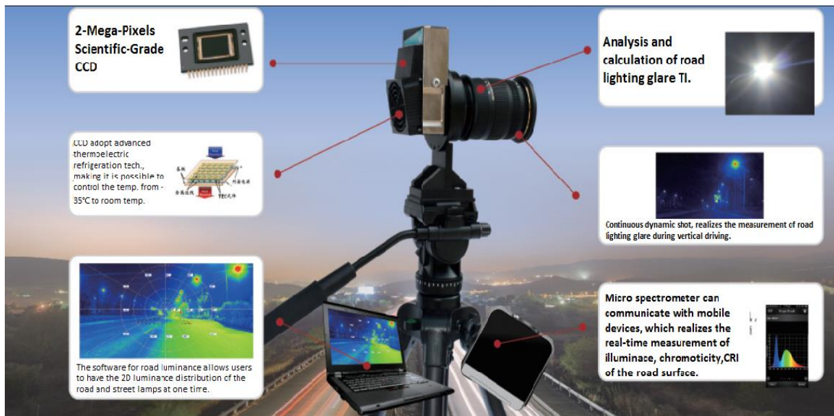
Σχήμα 13.4: Συσκευή ILMD και αναλυτική περιγραφή της
