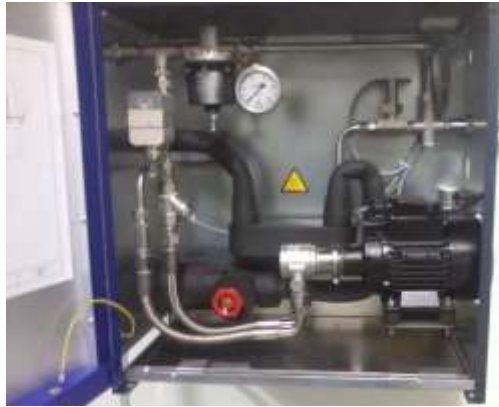
Εικόνα 17: Αντλία βενζίνης PFI (4 bar).
