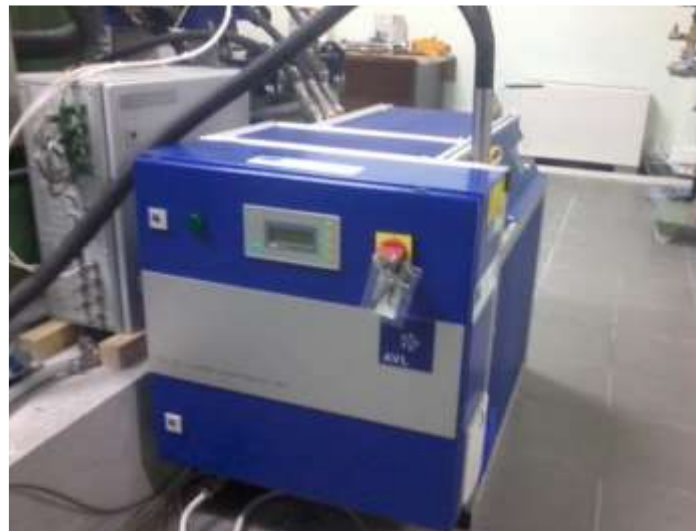
Εικόνα 19: Μονάδα προετοιμασίας αντιψυκτικού και λαδιού λίπανσης του οπτικού κινητήρα.
