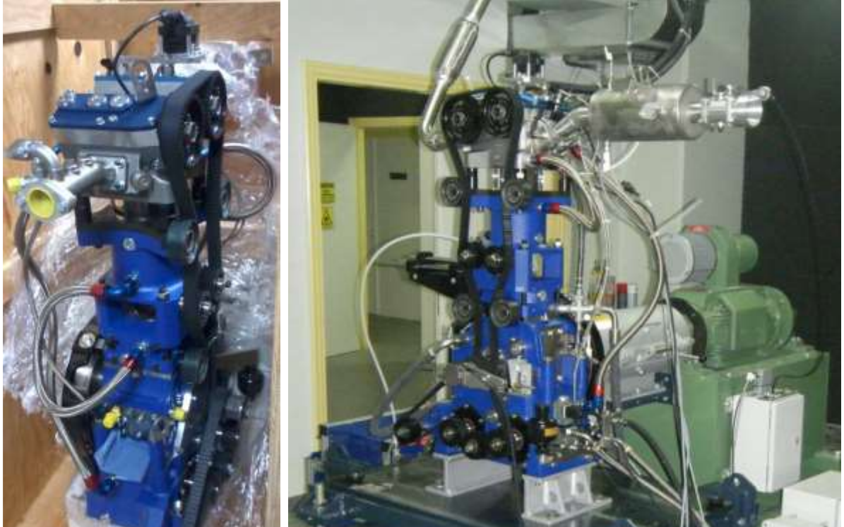
Εικόνα 14: Ο οπτικός κινητήρας FM54110 ανάφλεξης με σπινθήρα της AVL.
