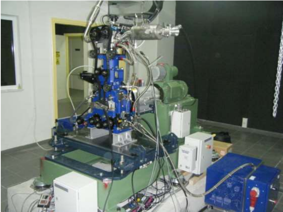
Εικόνα 10: Διάταξη οπτικού κινητήρα στο εργαστήριο μηχανών εσωτερικής καύσης του Π.Δ.Μ.
