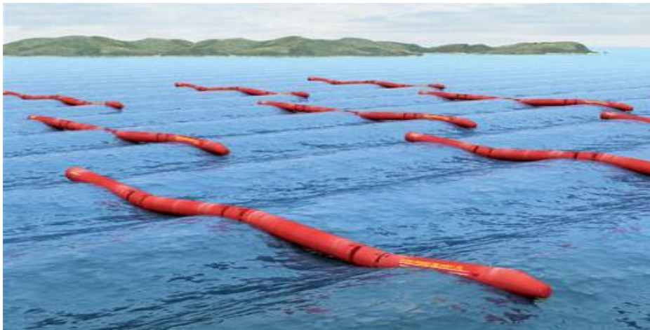
Σχήμα 7:Εκμετάλλευση κινητικής ενέργειας κυμάτων
