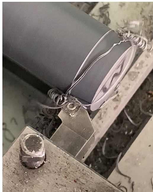
Εικόνα 4.5 : Τόρνευση PVC στις 112 rpm.
