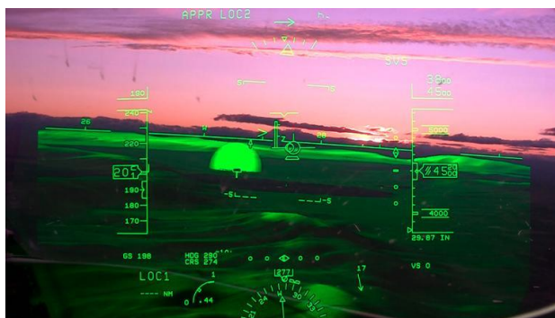
Εικόνα 1.6 Nasa's hybrid synthetic vision system
