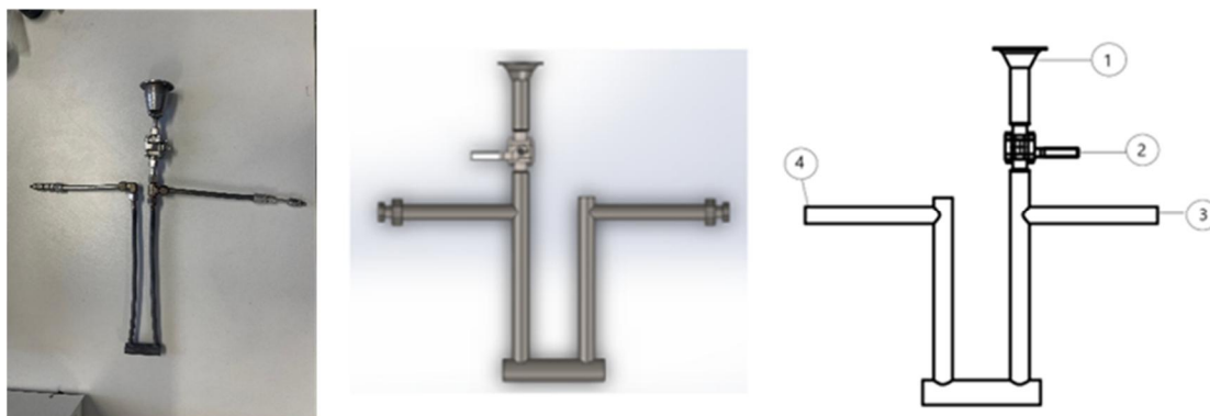
Εικόνα 14: Πειραματικός αντιδραστήρας αεριοποίησης σταθερής κλίνης..
