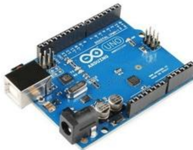
Εικόνα 14. Η βασική πλακέτα του Arduino
