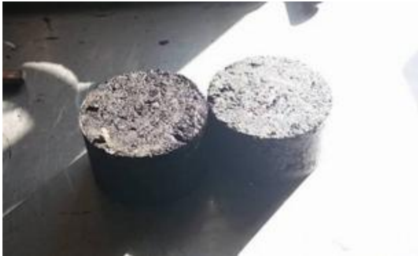
Εικόνα 2.20: Δείγματα ασφαλτικού σκυροδέματος
