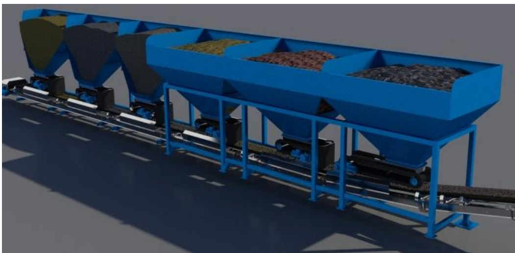
Εικόνα 2.2: Σύστημα προμήθειας αδρανών
