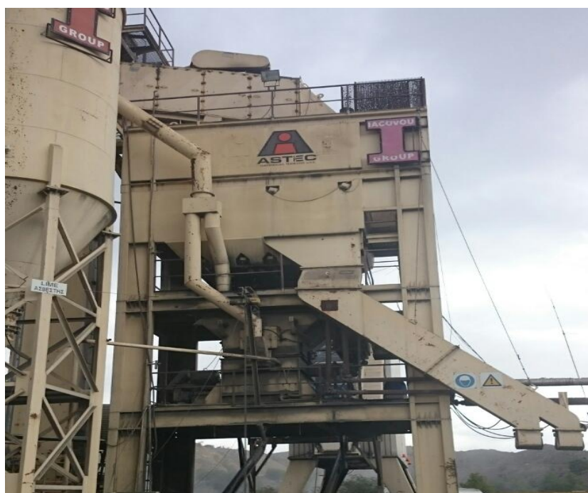
Εικόνα 2.13: Τροφοδοσία συνδετικής ύλης στον πύργο ανάμιξης
