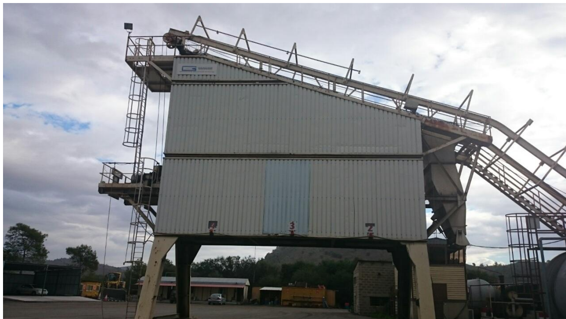
Εικόνα 2.17: Αποθήκευση και διάθεση ασφαλτικού σκυροδέματος
