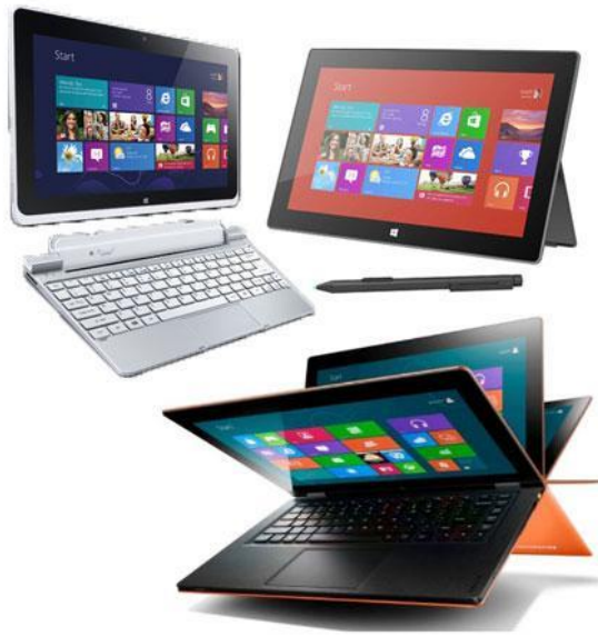
Εικόνα 7: Υβριδικό (Hybrid) tablet PC
