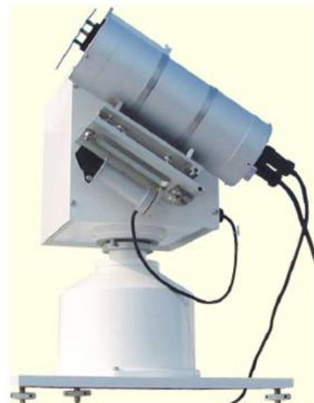
Σχήμα 2.4: Το ζωνοπερατό, Ηλιακό φωτόμετρο με φασματικό εύρος 440-1020 nm και μέτρηση της F_{A,obs} μέσω 8 ζωνοπερατών φίλτρων. Το περιθλαστικό φασματοφωτόμετρο με φασματικό εύρος 309-1055 nm και μέτρηση της F_{A,obs} μέσω 1032 καναλιών.
