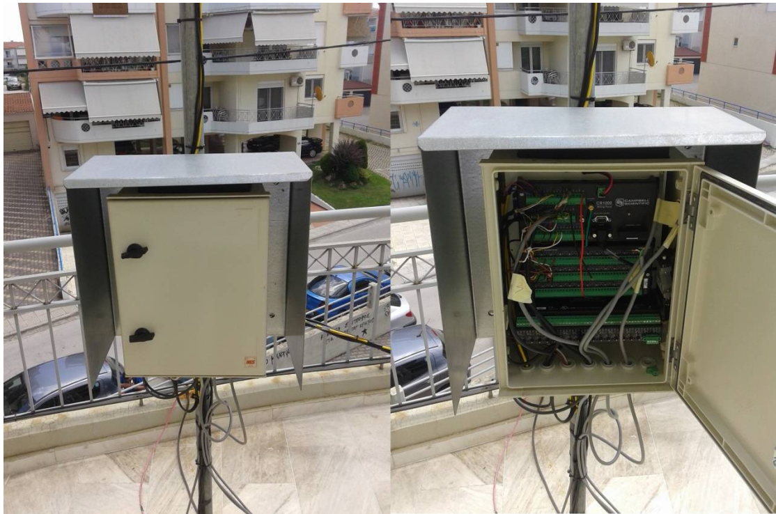
Σχήμα 4.5: Εγκατάσταση του Data Logger στον πειραματικό χώρο δοκιμών.
