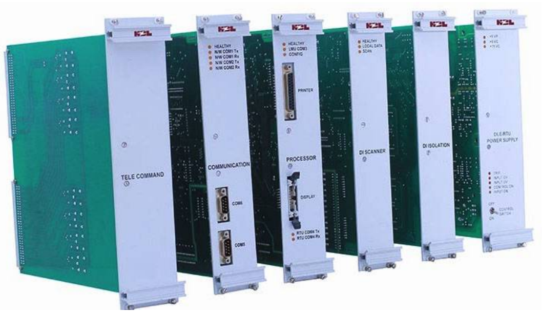
Σχήμα 4.2: Data Logger τύπου κάρτας για εσωτερικό χώρο δοκιμών.
