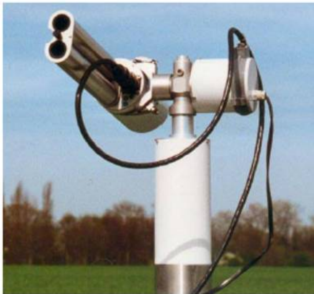
Σχήμα 2.4: Το ζωνοπερατό, Ηλιακό φωτόμετρο με φασματικό εύρος 440-1020 nm και μέτρηση της F_{A,obs} μέσω 8 ζωνοπερατών φίλτρων. Το περιθλαστικό φασματοφωτόμετρο με φασματικό εύρος 309-1055 nm και μέτρηση της F_{A,obs} μέσω 1032 καναλιών.
