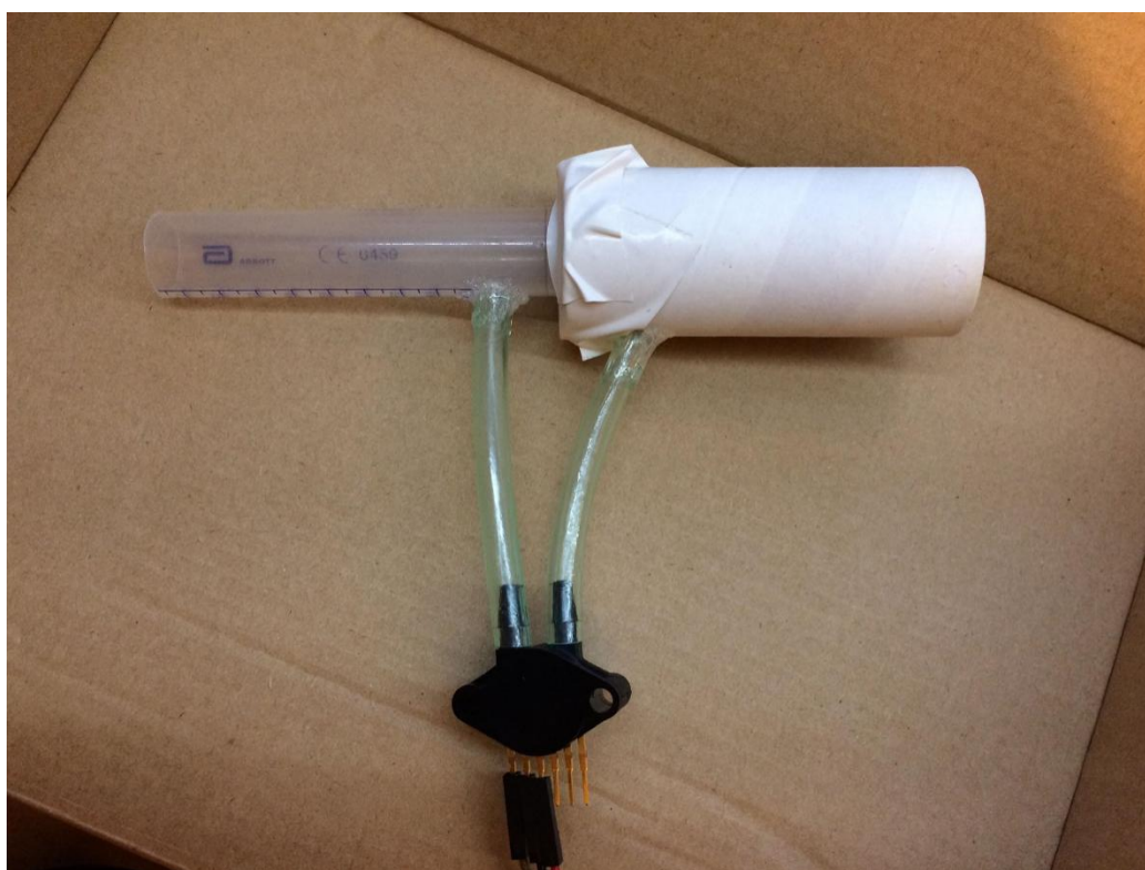
Εικόνα 12. Σπιρόμετρο και αισθητήρας που χρησιμοποιήθηκε.
