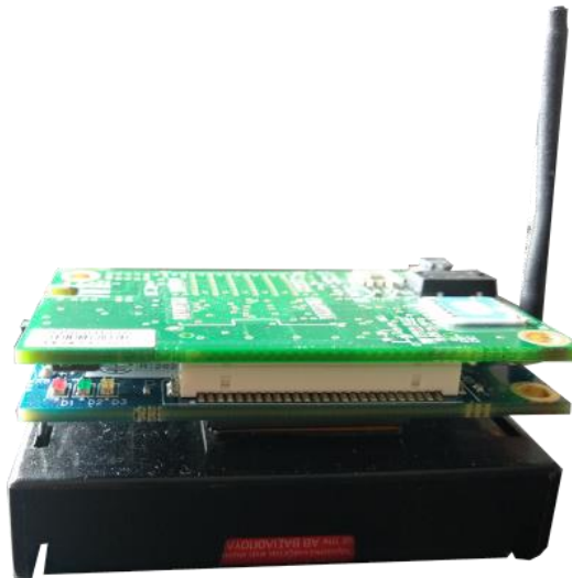
ΕΙΚΟΝΑ 5.14 IRIS XM2110 ΜΟΤΕ ΣΥΝΔΕΔΕΜΕΝΟ ΜΕ ΑΙΣΘΗΤΗΡΑ MTS400 ΜΑΖΙ ΜΕ ΠΗΓΗ ΕΝΕΡΓΕΙΑΣ (ΜΠΑΤΑΡΙΕΣ ΑΑ)
