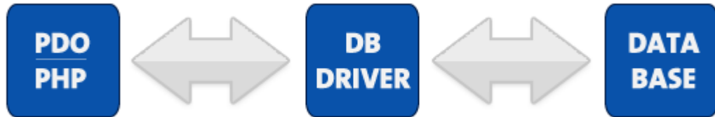
ΕΙΚΟΝΑ 3.12 ΔΙΕΠΑΦΗ ΠΡΟΣΒΑΣΗΣ ΣΕ ΜΙΑ ΒΑΣΗ ΔΕΔΟΜΕΝΩΝ ΜΕ ΤΗ ΧΡΗΣΗ PDO
