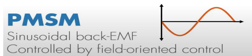
Εικόνα 2.2.7: Η διαφορά στη κυματομορφή μεταξύ των BLDC και PMSM, με την τραπεζοειδή και ημιτονοειδή μορφή αντίστοιχα να τους διακρίνει [17]
