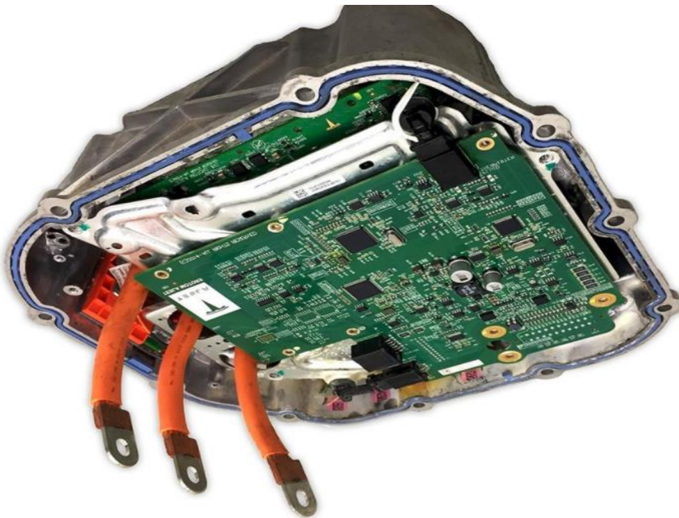
Εικόνα 3.1: Ο μετατροπέας DC/AC (Inverter) που ενσωματώνεται στο πίσω σύστημα κίνησης ενός Tesla Model S δύο ηλεκτροκινητήρων [25]
