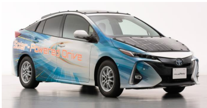
Εικόνα 7.3: Τοποθέτηση φωτοβολταϊκών πάνελ στο αμιγώς ηλεκτρικό μοντέλο της Toyota, το Prius EV
