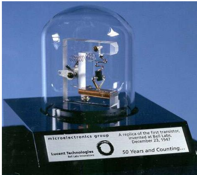
Εικόνα 2.3.2: Το 1997 η εταιρεία Lucent Technologies, ενόψει τον 50 χρόνων από την ανακάλυψη του τρανζίστορ, δημιουργεί ένα πιστό αντίγραφο του πρώτου τρανζίστορ των Shockley, Brattain και Bardeen, όπως παρουσιάστηκε το 1947. [20]
